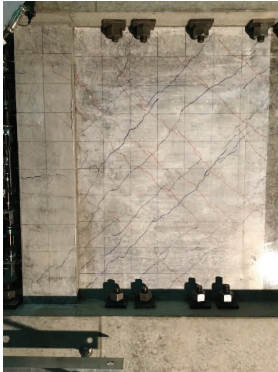
図 2-11 試験体 S-06-D II 事前加力終了時 (2/1000rad.) 写真
