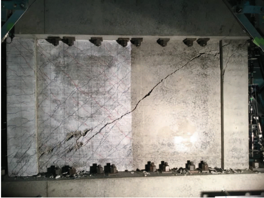
図 2-14 試験体 S-06-DIII 最終破壊時写真
