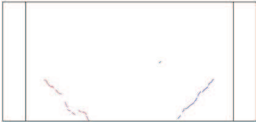
図 3-4 (1) 1/5000rad. におけるひび割れ図
