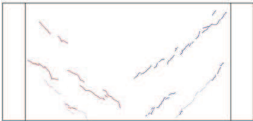
図 3-4 (2) 1/3333rad. におけるひび割れ図
