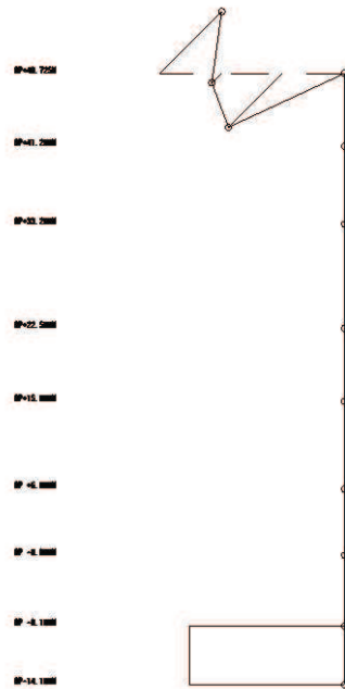
図 3-25 第 3 号機原子炉建屋 固有振動モード (鉛直方向)
