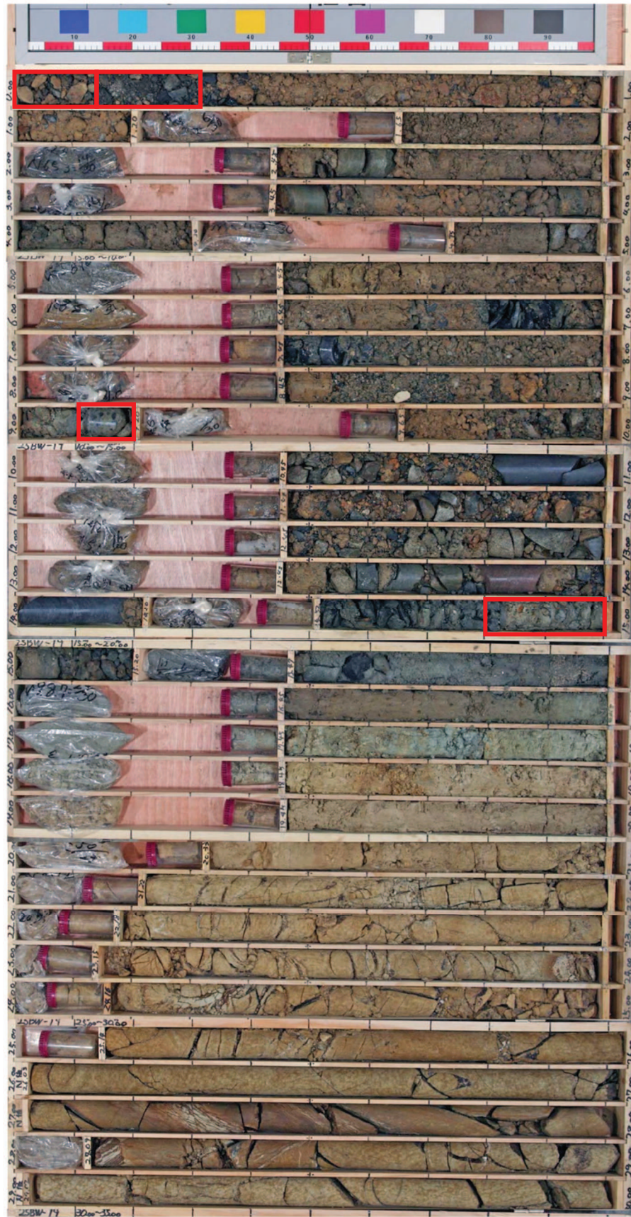
図 1-22(2) ボーリングコア写真 (25BW-19) (盛土：深度 0～15.20m, 旧表土：深度 15.20～16.90m)
