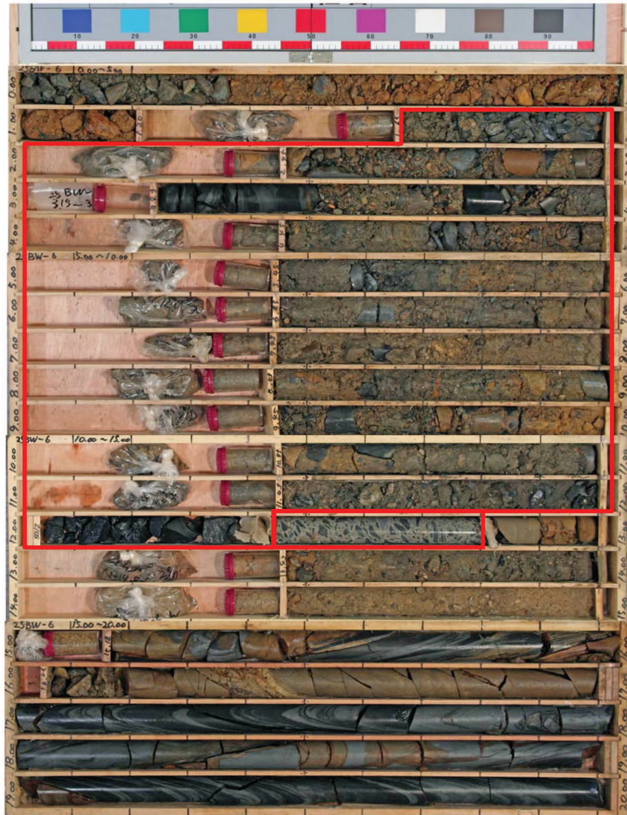
図 1-9(2) ボーリングコア写真 (25BW-6) (盛土：深度 0～14.00m, 旧表土：深度 14.00～15.18m)
