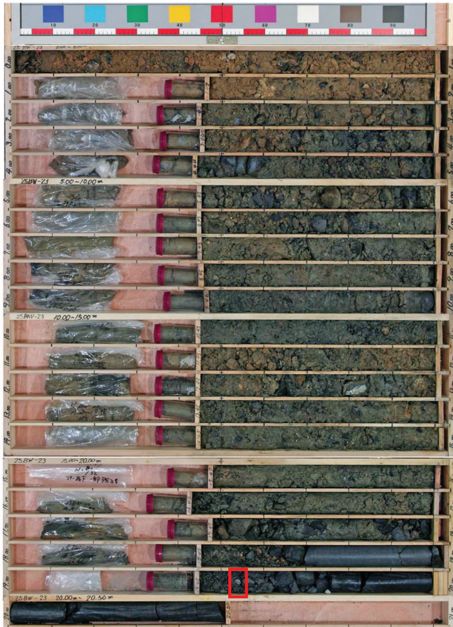
図 1-26(2) ボーリングコア写真 (25BW-23) (盛土：深度 0～19.76m)
