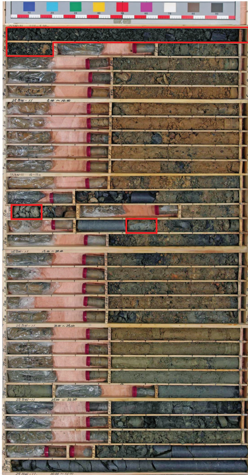
図 1-14(2) ボーリングコア写真 (25BW-11) (盛土 : 深度 0 ~ 19.96m, 旧表土 : 深度 19.96 ~ 28.63m)
