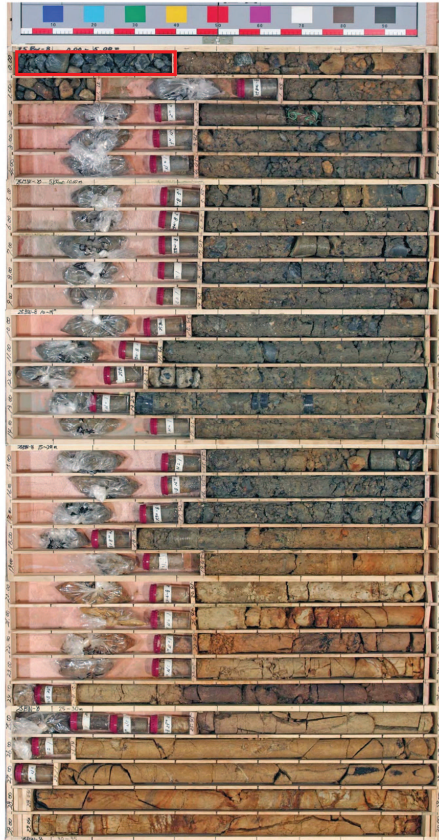
図 1-11(2) ボーリングコア写真 (25BW-8) (盛土 : 深度 0~19.72m, 旧表土 : 深度 19.72~20.00m)
