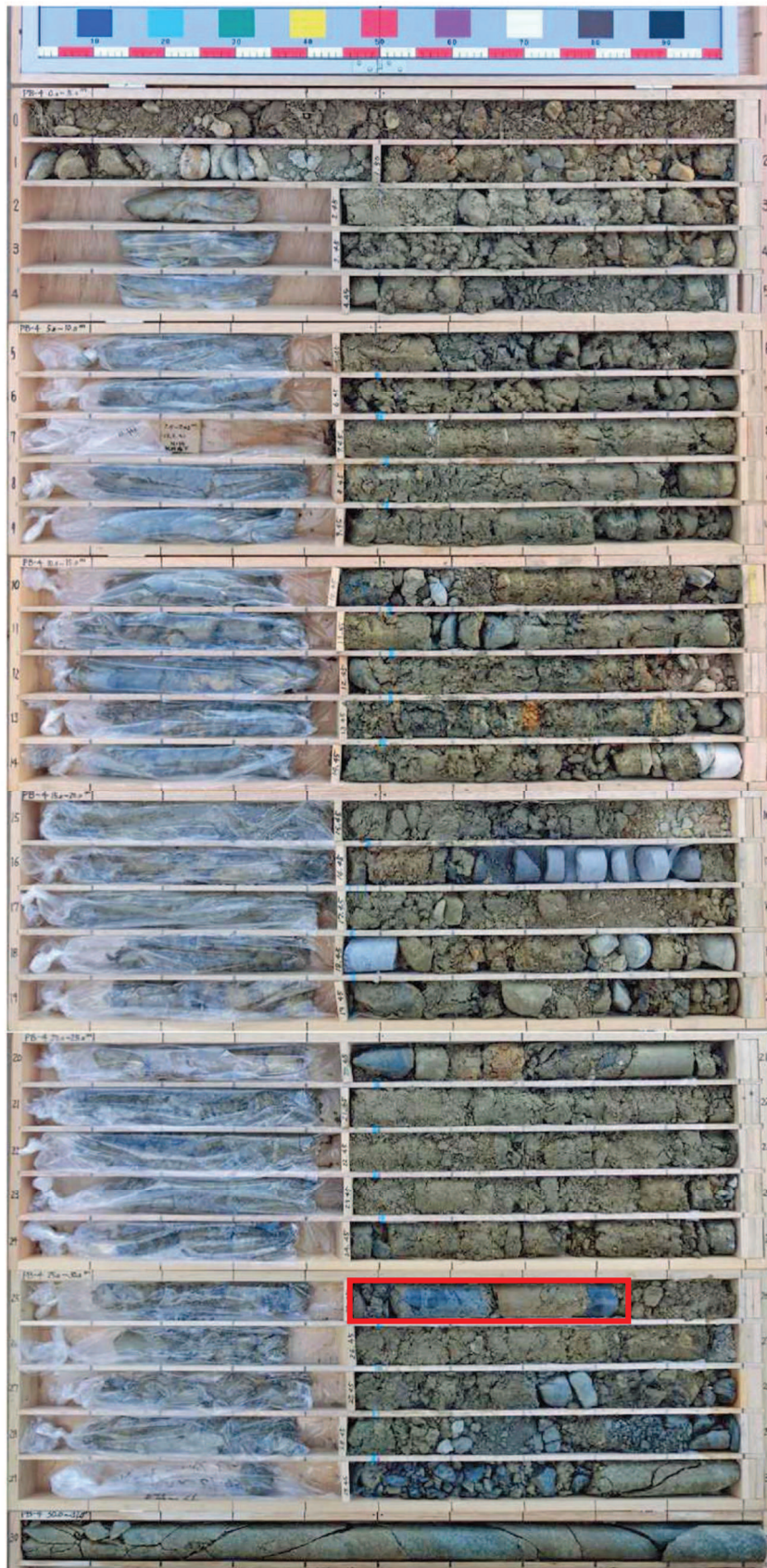
図 1-5(2) ボーリングコア写真 (PB-4) (盛土: 深度 0~29.80m)
