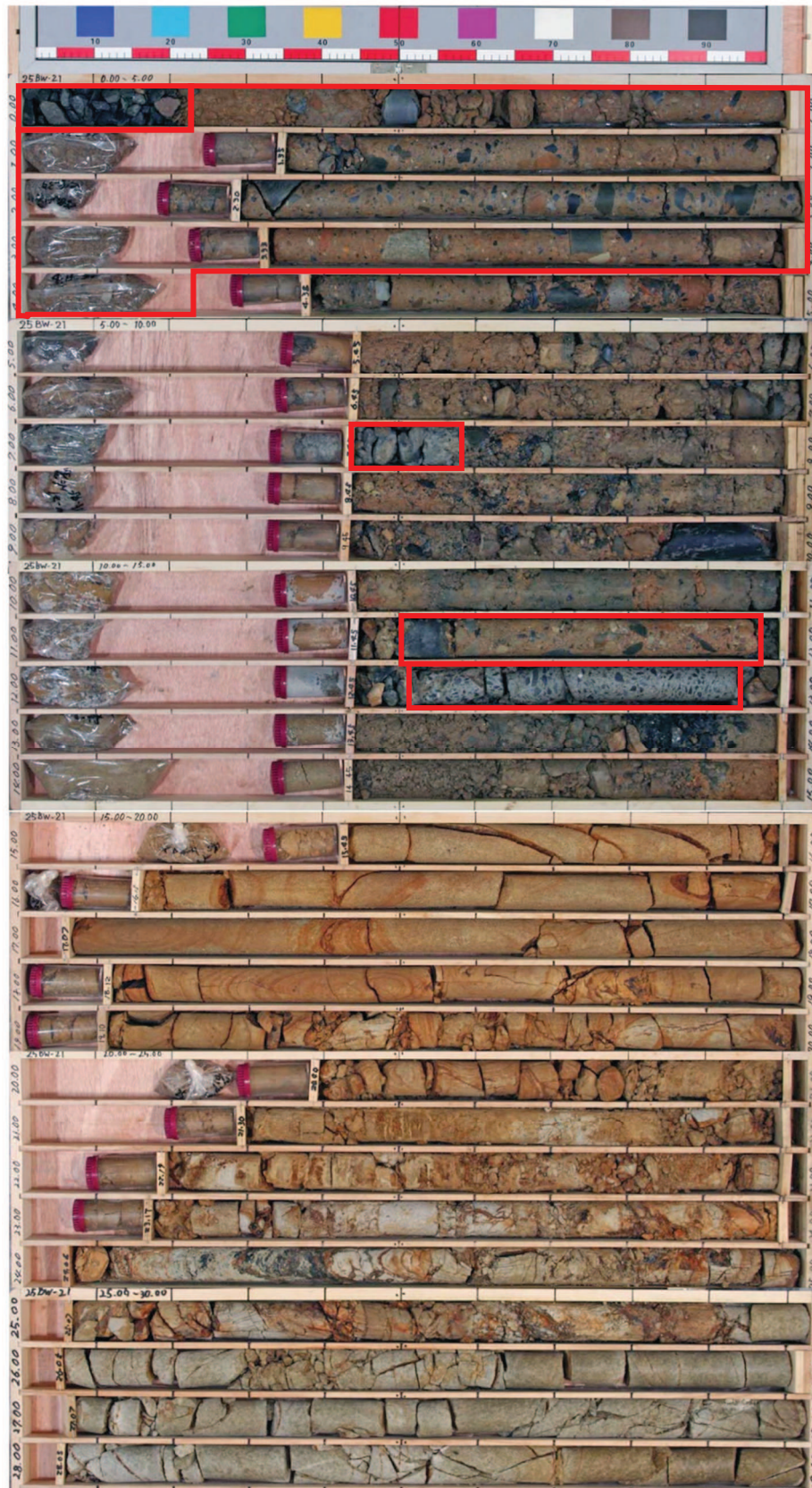
図 1-24(2) ボーリングコア写真 (25BW-21) (盛土：深度 0～12.94m, 旧表土：深度 12.94～14.94m)
