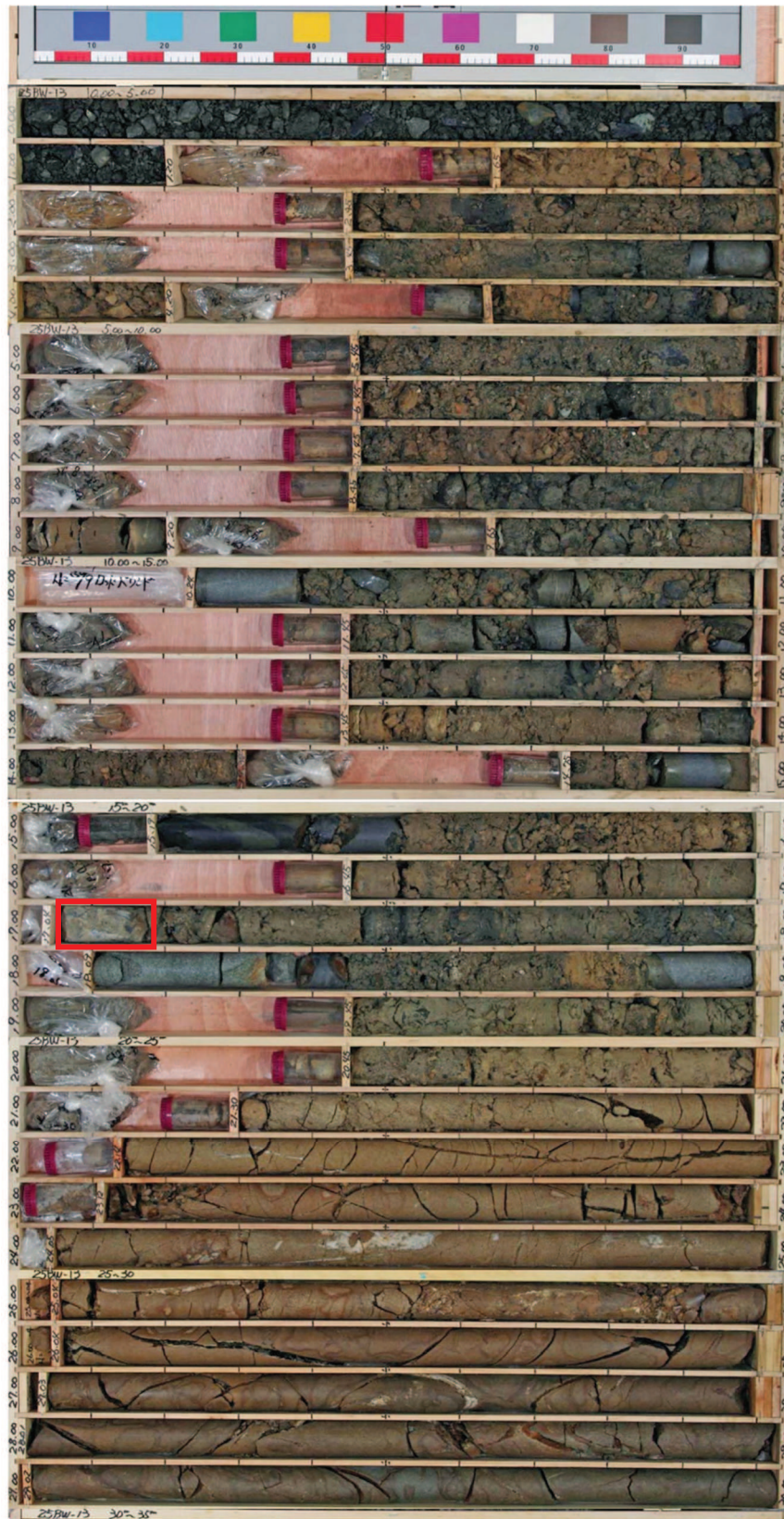
図 1-16(2) ボーリングコア写真 (25BW-13) (盛土：深度 0～19.00m, 旧表土：深度 19.00～20.87m)
