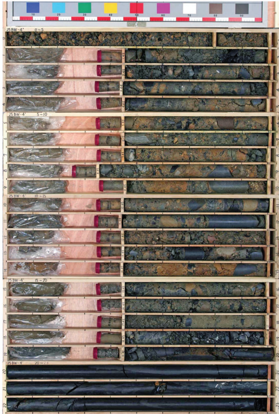
図 1-7(1) ボーリングコア写真 (25BW-4) (盛土: 深度 0~19.57m)
