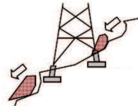
【急傾斜地の崩壊】
