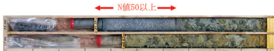
ボーリングコア写真(28QB-4-1 : 23.00m~25.00m)
