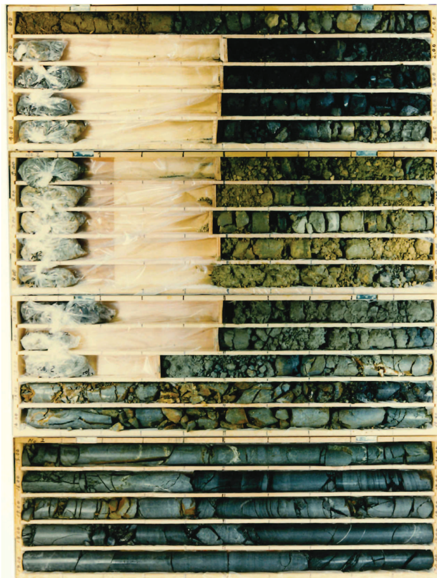
図 1-46(2) ボーリングコア写真 (No. 2) (盛土 : 深度 0~9.90m, 旧表土 : 深度 9.90~11.95m)
