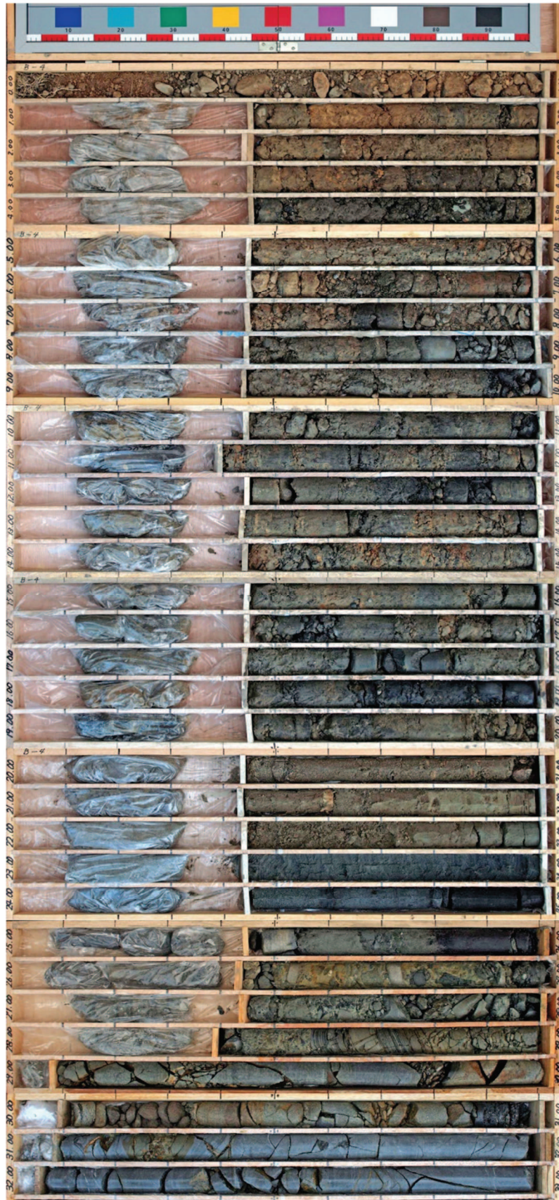
図 1-48(2) ボーリングコア写真 (23B-4) (盛土：深度 0～19.70m, 旧表土：深度 19.70～28.57m)
