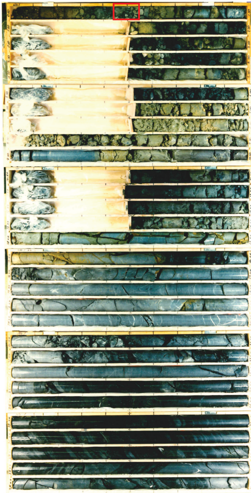
図 1-45(2) ボーリングコア写真 (No. 1) (盛土 : 深度 0~9.70m, 旧表土 : 深度 9.70~14.18m)
