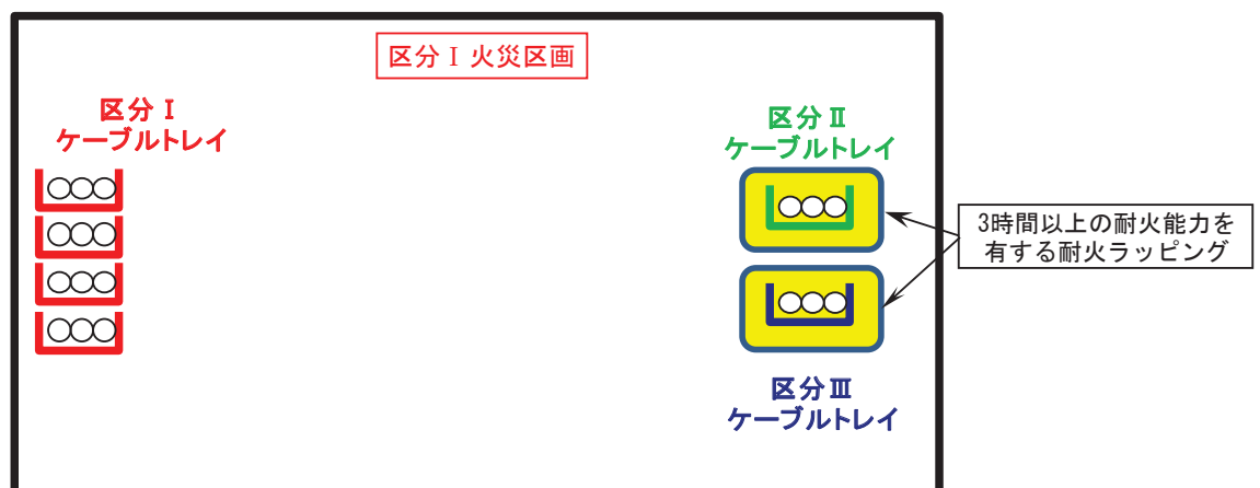
図2 ケーブルトレイ3時間ラッピングの概要
