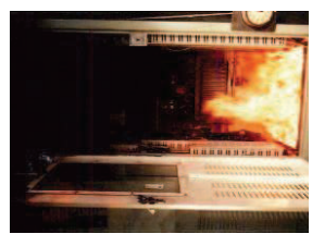
制御盤の油点火試験中
