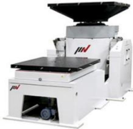
図 5-1 振動台の概要図
