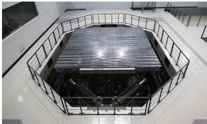
図 4-1 三次元振動台の概要図
