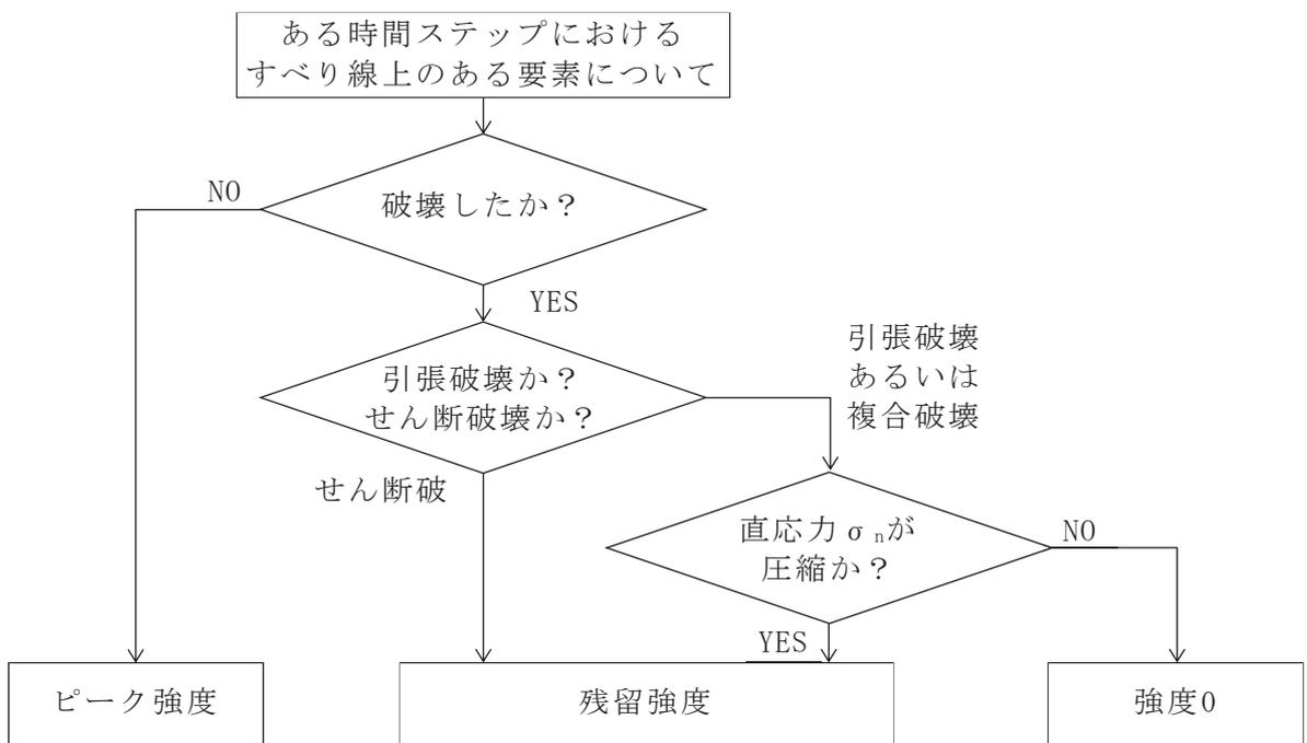
図3-2 破壊判定フローチャート
