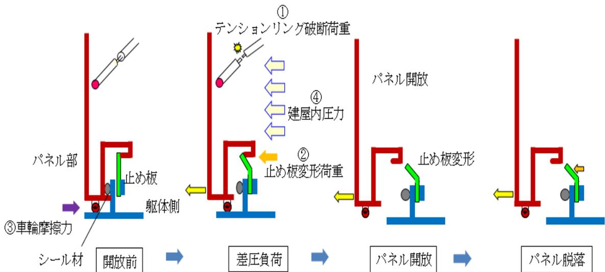
図 3-1 原子炉建屋 BOP 開放のメカニズム
