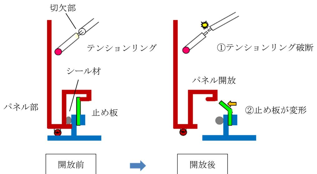
図 2-1 原子炉建屋 BOP の構造と作動原理
