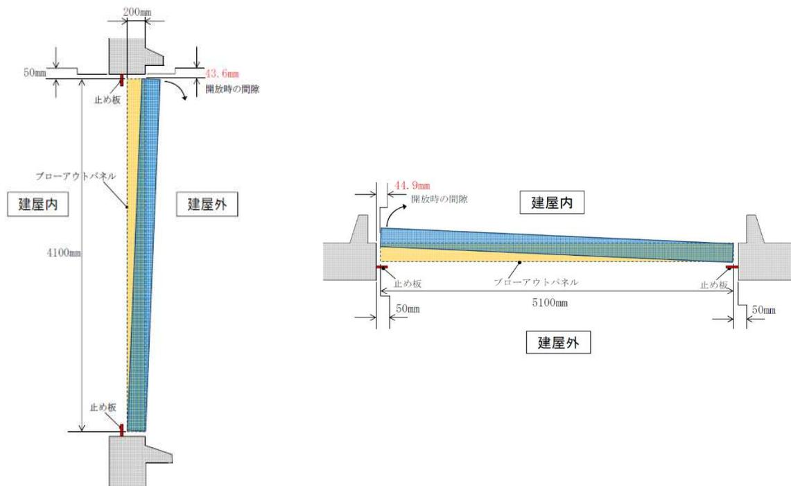
図1-1 原子炉建屋BOP開放時の縦・横断面図
