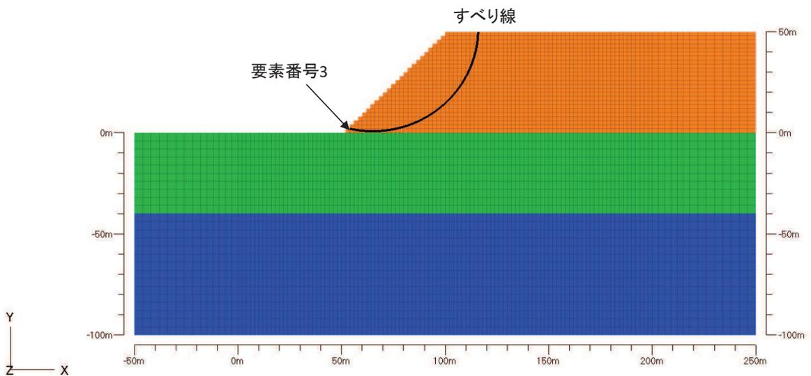
図4.1-1 解析モデル及び検証用すべり線
