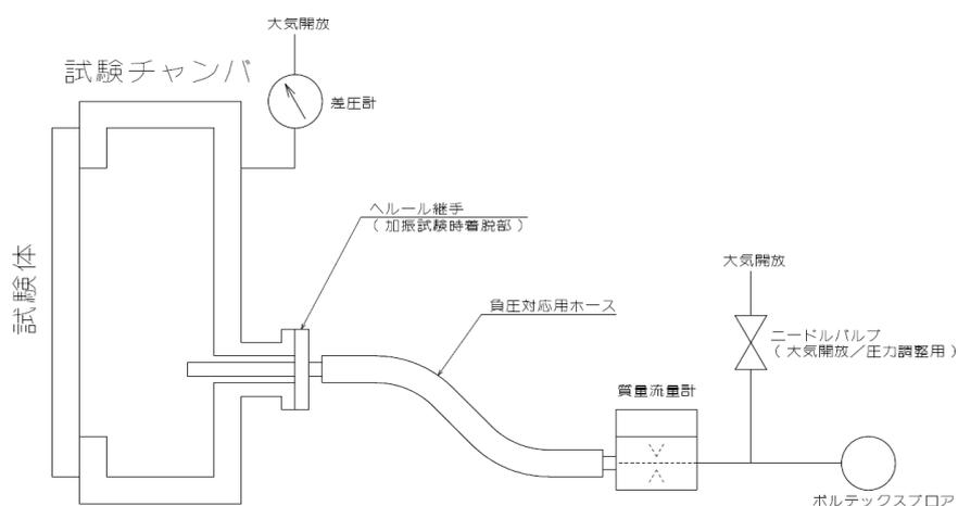
図 5-1 BOP 閉止装置気密性能試験装置図
