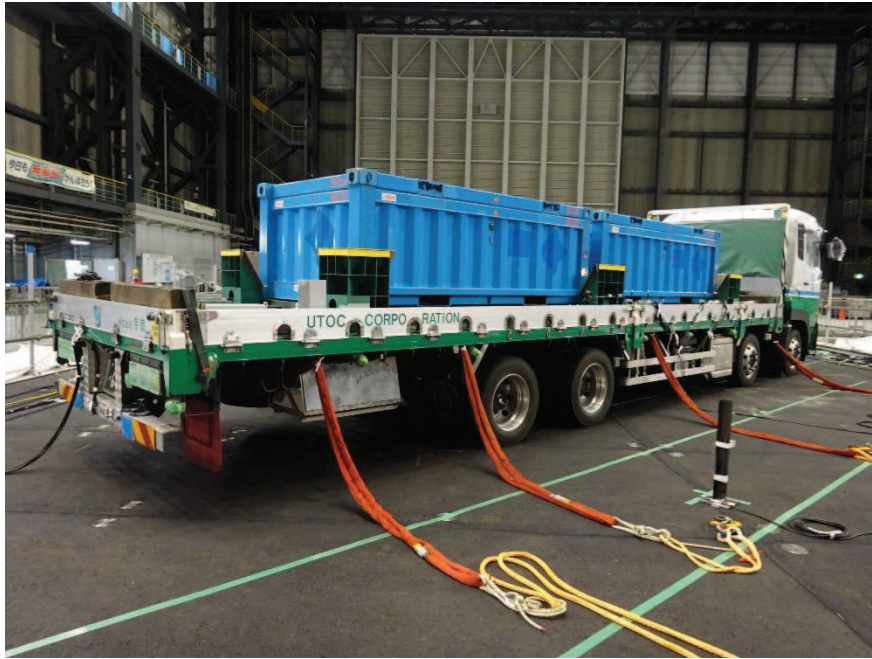
図9 加振試験時のLLW輸送車両
