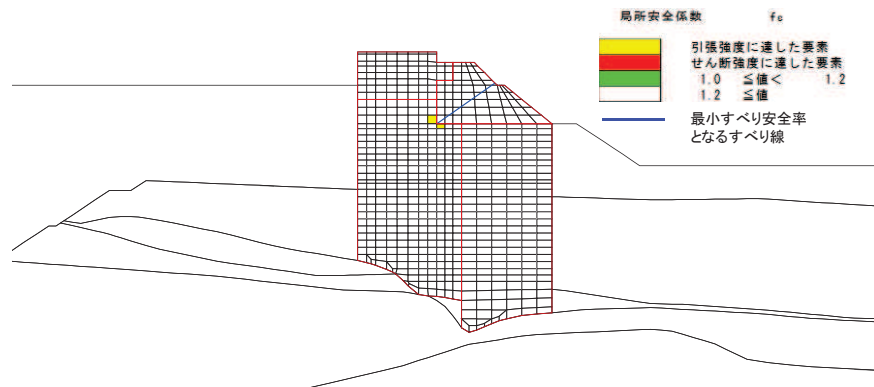
図 5.5-5 セメント改良土のすべり安全率時刻における局所安全係数分布 (断面②, S s - D 2 ( - - ) , t=13.58)
