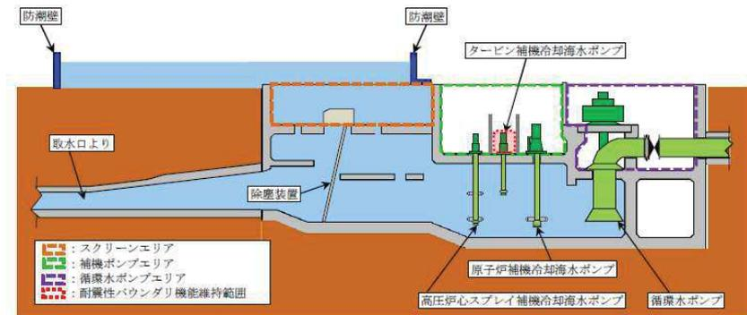
図 3-40 海水ポンプ室補機ポンプエリアの耐震性バウンダリ機能維持範囲 (断面図)
