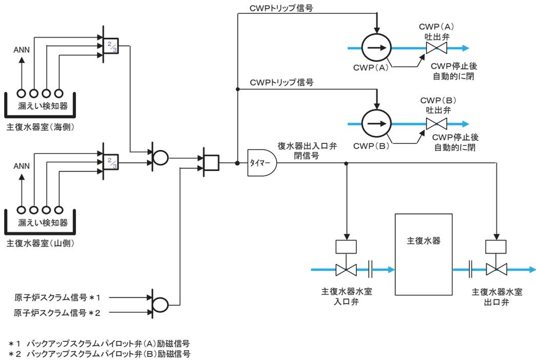
図 3-31 循環水系隔離システムの概要
