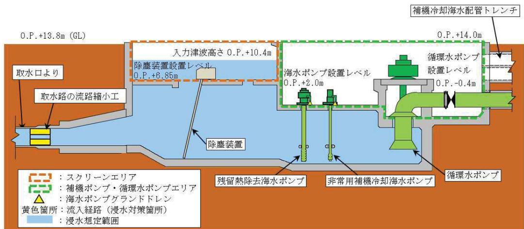
図 3-7 第 1 号機 海水ポンプ室 浸水対策配置図 (A-A 断面図)
