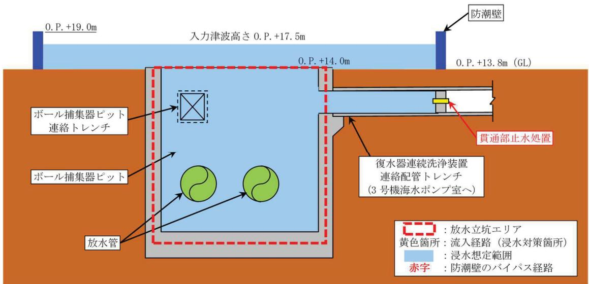
図 3-20 第 3 号機 放水立坑 浸水対策配置図 (B-B 断面図)
