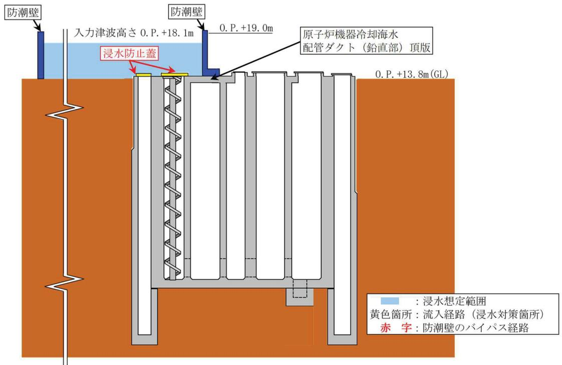
図 3-5 第 2 号機 海水ポンプ室 浸水対策配置図 (B-B 断面図)
