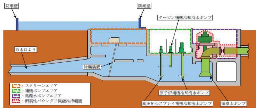
図 3-38 海水ポンプ室循環水ポンプエリアの耐震性バウンダリ機能維持範囲
