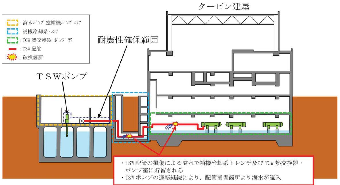
図 3-32 タービン補機冷却海水系配管からの溢水の評価方針の概要
