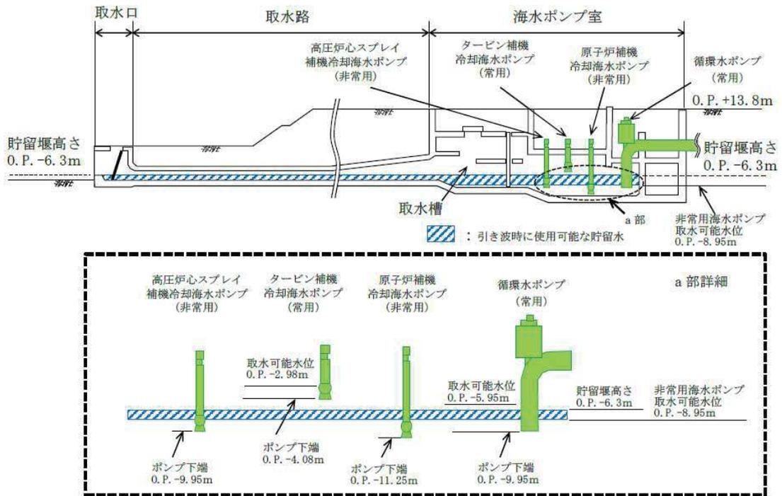
図 3-47 取水設備構造概要
