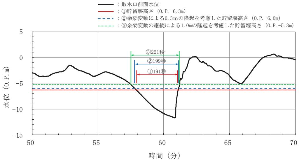
図 3-48 取水口前面における入力津波による水位時刻歴波形 (水位下降側)
