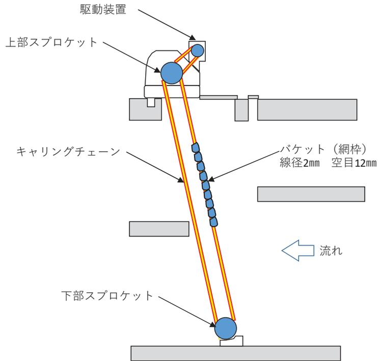
図 3-55 除塵装置構造図 (バケット型スクリーン)
