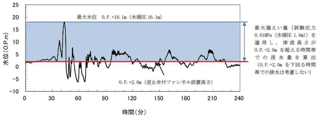
図 3-29 逆止弁付ファンネルからの浸水量評価適用図
