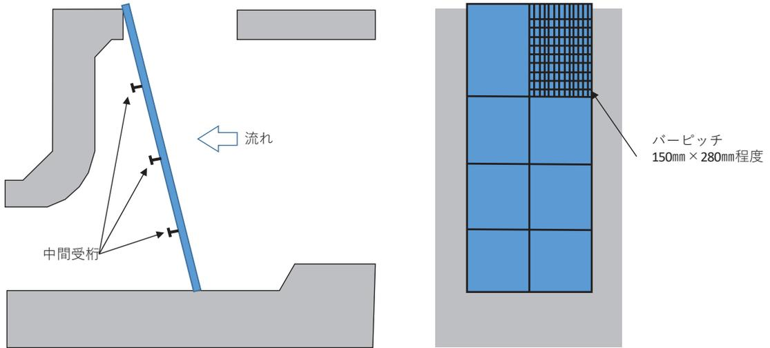
図 3-54 除塵装置構造図 (固定式バースクリーン)
