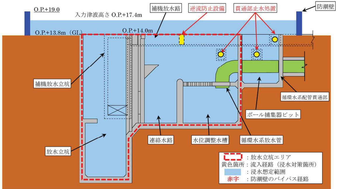
図 3-15 第 2 号機 放水立坑 浸水対策配置図 (B-B 断面図)
