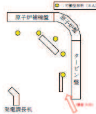
第 1-1-4-1 図 シミュレータ施設における可搬型照明（SA）確認状況
