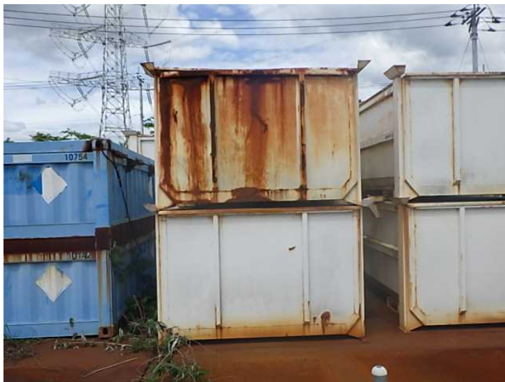
コンテナ(福島県職員殿情報) 表面線量0.48mSv/h、側面腐食
