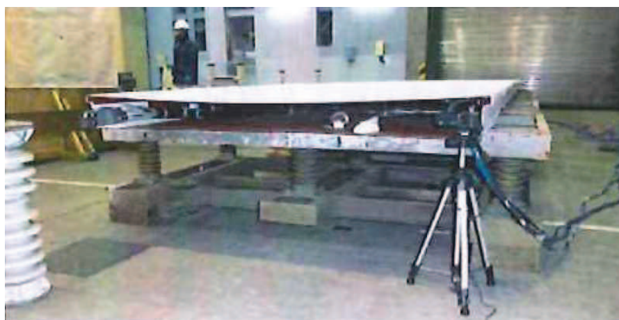
図 3 消火実証試験用のケーブルトレイ外観
