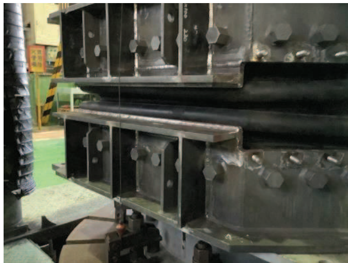
図 6.1.5-12(2) ゴムジョイント設置状況
