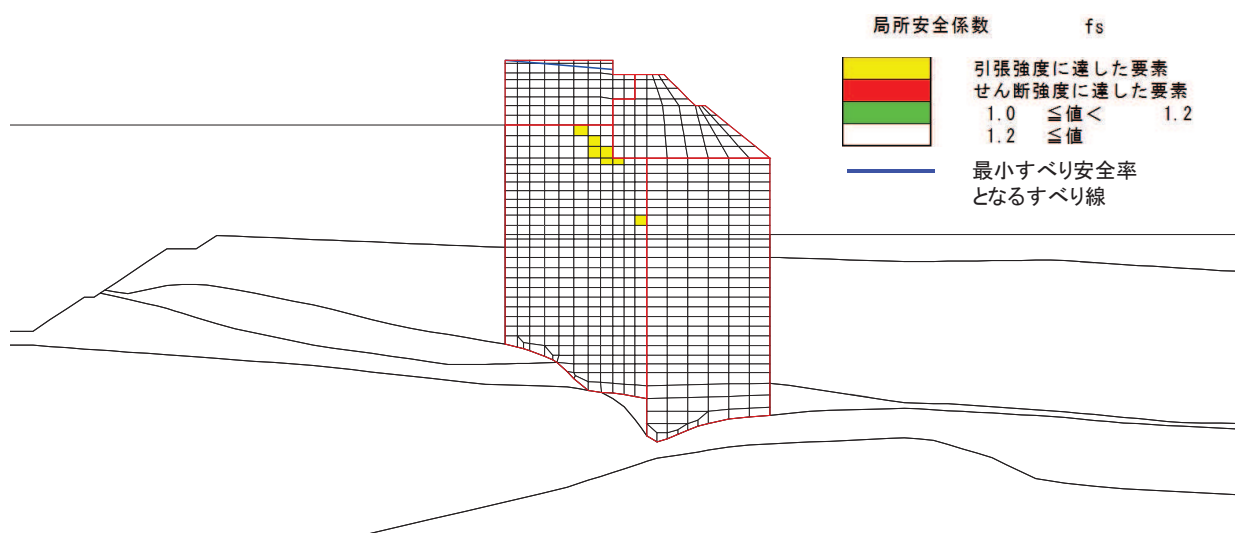
図 3-3 背面補強工の最小すべり安全率時刻における局所安全係数分布 (断面②, ジョイント要素追加設定)
