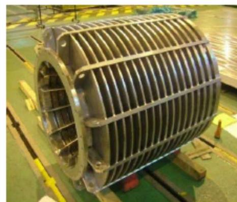
ディスクを積層させることで表面積を増加させ、閉塞に関する裕度を上げる
