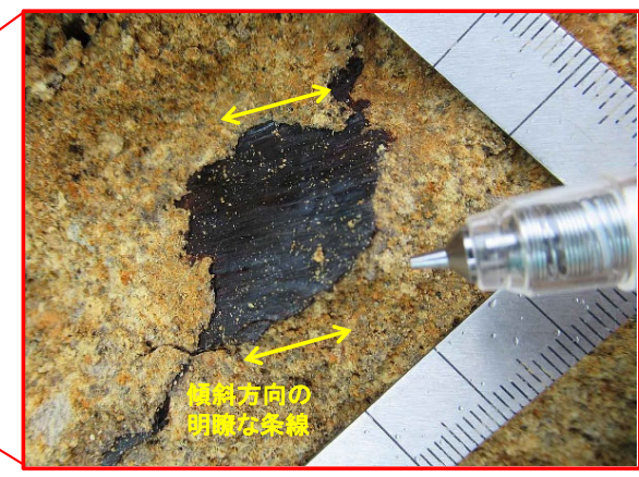
pd系弱面b ・ 走向・傾斜:N79° E, 40° N ・ 傾斜方向の明瞭な条線有り(プランジ角38° N)
