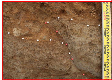
低角の変位を伴う不連続面の変位が段丘堆積物中にまで達する部分(右: 解釈線有り, 左: 解釈線なし)
