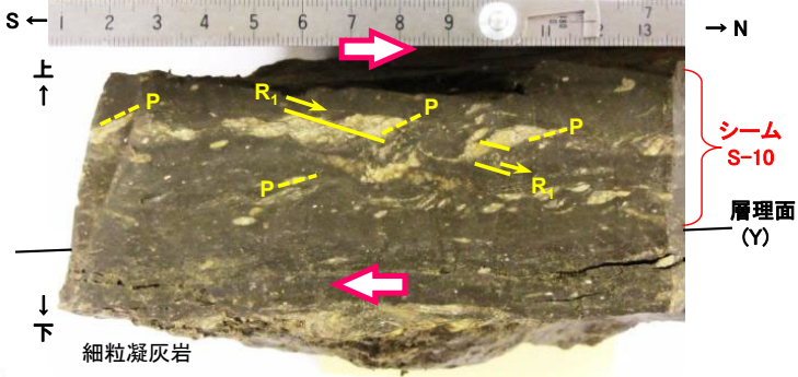
シームS-10内部の複合面構造 (補足調査坑ブロック試料:層理面に直交するNS断面) 凡例
