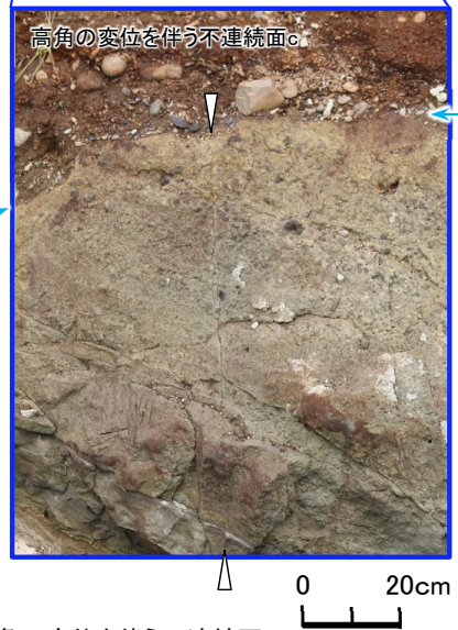
高角の変位を伴う不連続面c ・ 走向・傾斜:N46° E, 84° N ・ M 3 面段丘堆積物に変位・変形を与えていない。
