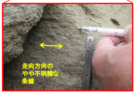
高角の変位を伴う不連続面b ・新鮮部 ・走向・傾斜:N39° E, 60° W ・走向方向のやや不明瞭な条線有り
