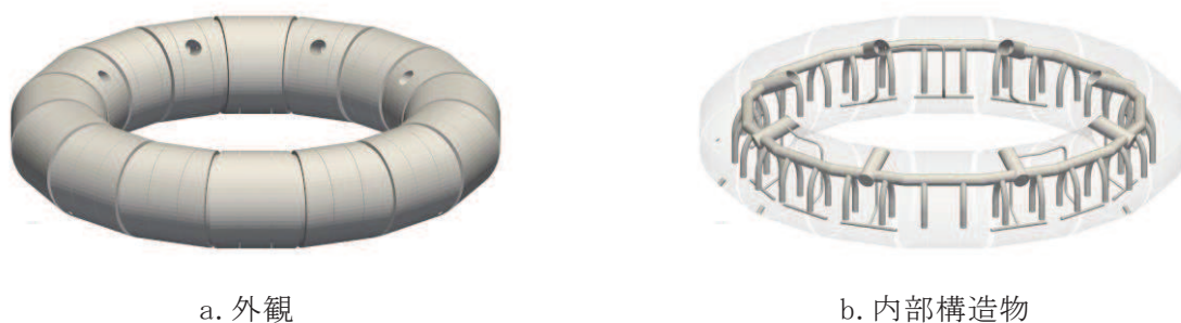
図23 流体解析に用いる実機解析モデル
