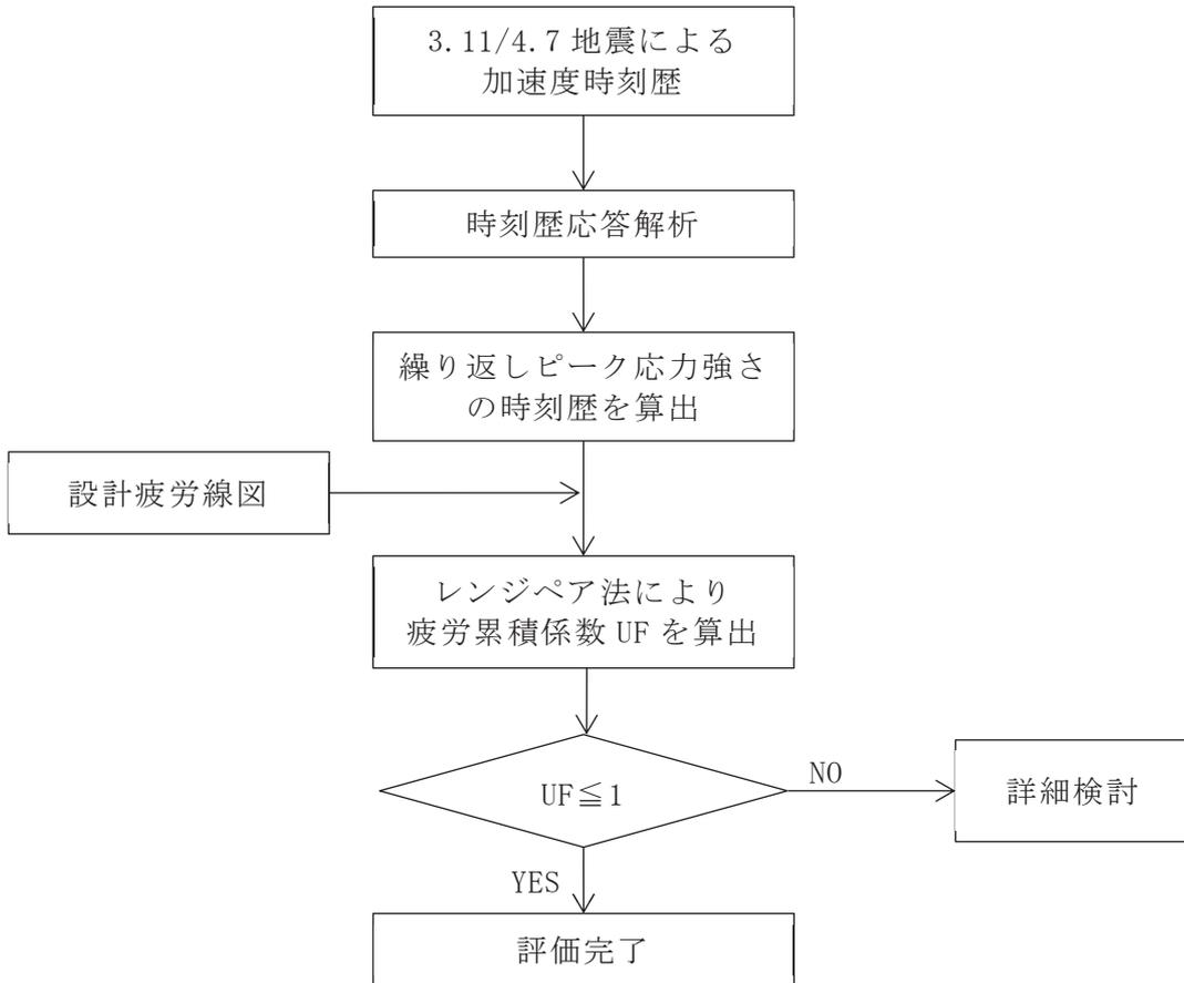
図 4-3 3.11/4.7 地震に対する疲労評価のフロー
