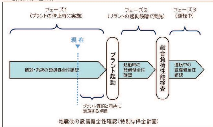
【機器・配管系の地震後の設備健全性確認(フェーズ1)の概要】
