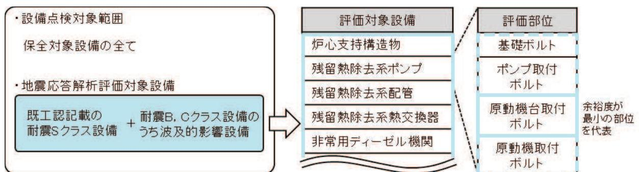
図 4-1 評価対象選定の考え方の概要図
