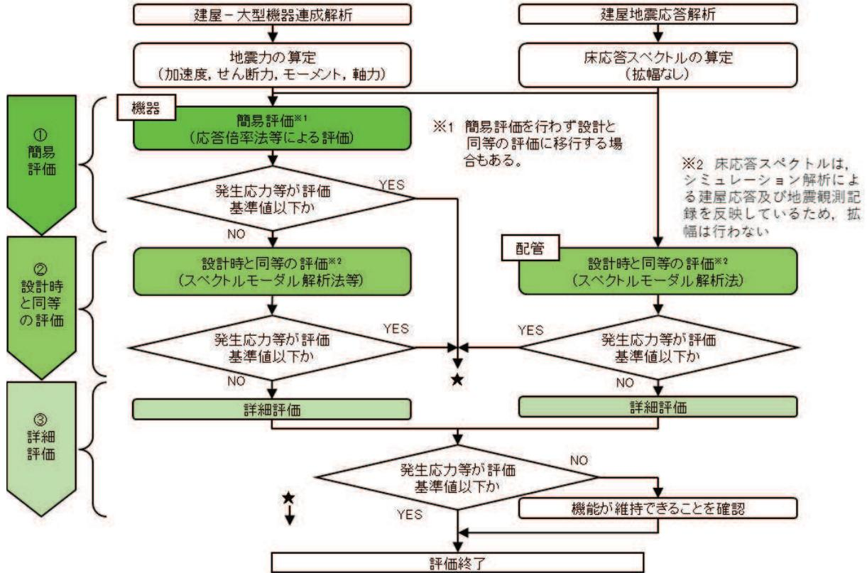
図 4-4 地震応答解析の評価フロー
