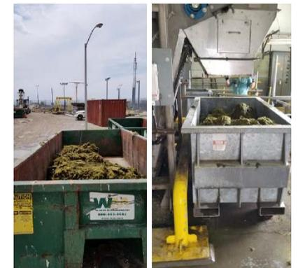
図 藻類捕集容器(左)と除去装置(右)
