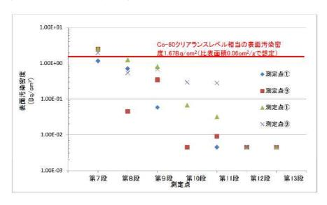
・主蒸気入口側である第7段目付近はCo-60のクリアランスレベル相当の表面汚染密度であり、下流側の第12段、第13段目は表面汚染密度が検出されなかった。 (2号炉低圧ダイヤフラム 周方向)
