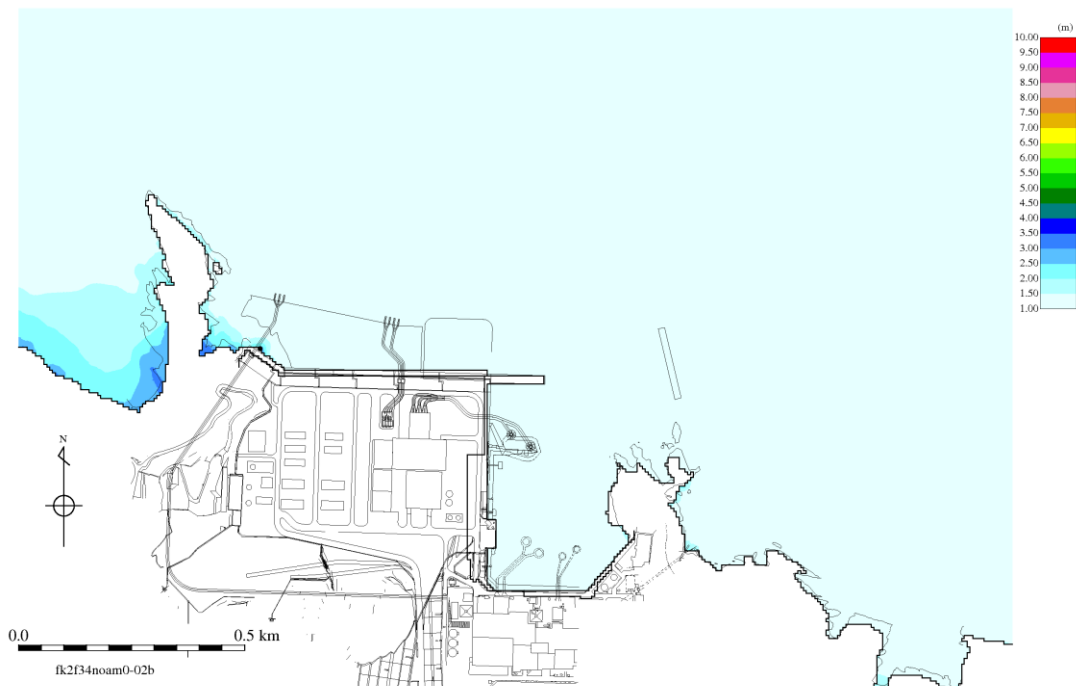
第1.5-5図(1) 基準津波の遡上波による最高水位分布 (基準津波 1 : 防波堤無し)
