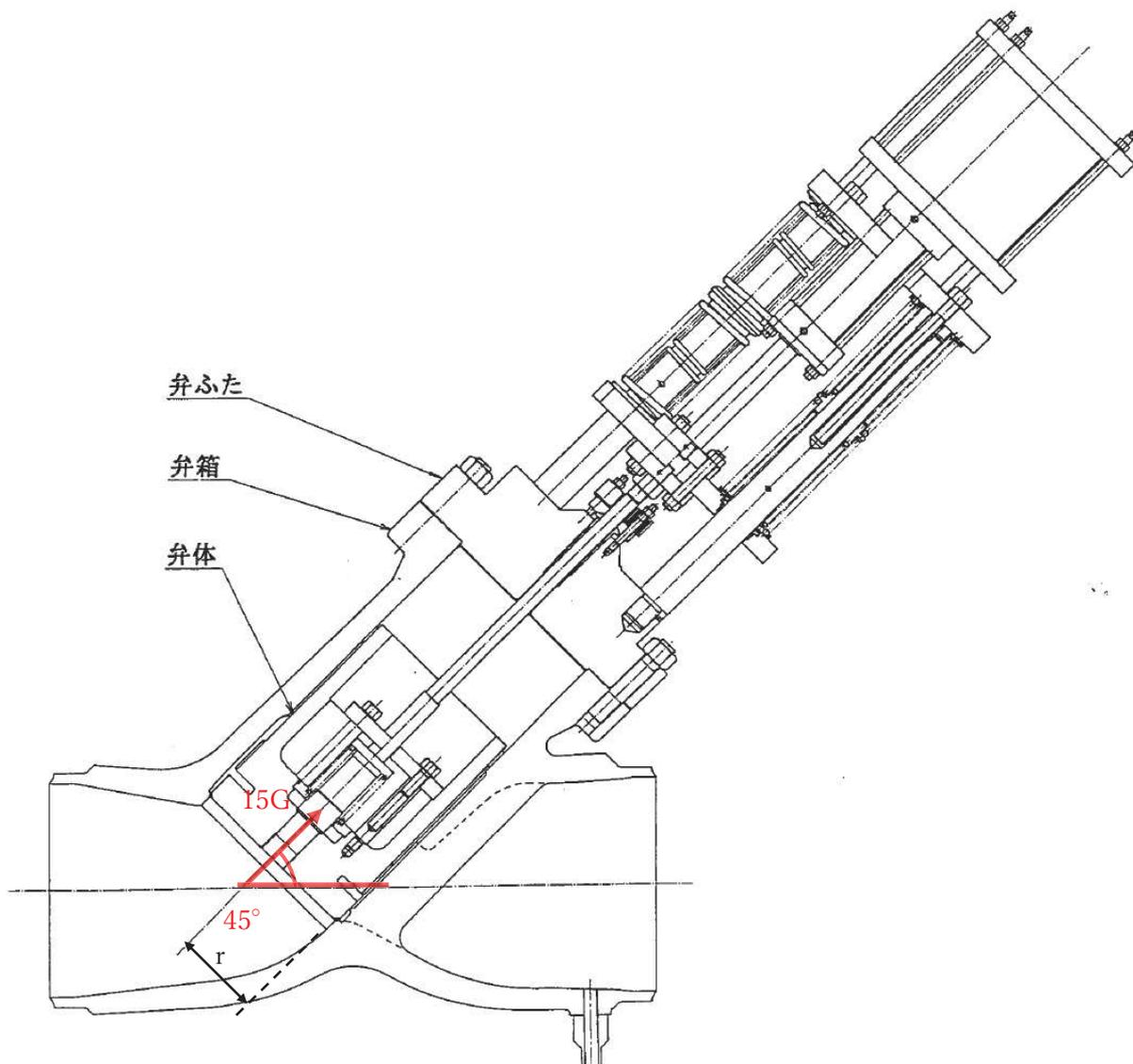
添付 9-6 図 主蒸気系境界弁構造図
