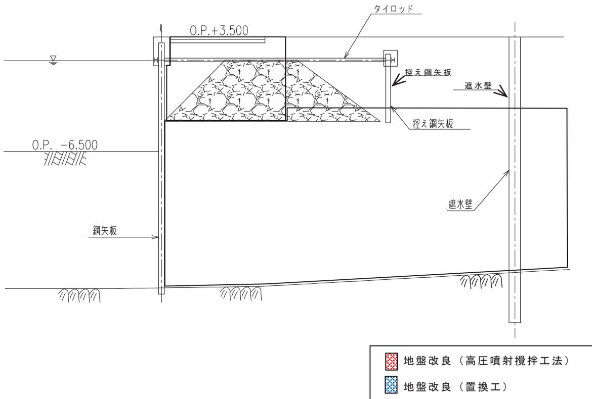
添付 6-9 図 前面護岸の断面図 (B-B 断面)
