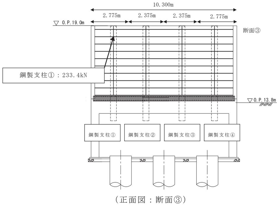
添付 8-7(3) 図 第 3 号機ガスボンベ庫による鋼製遮水壁（鋼板）の
