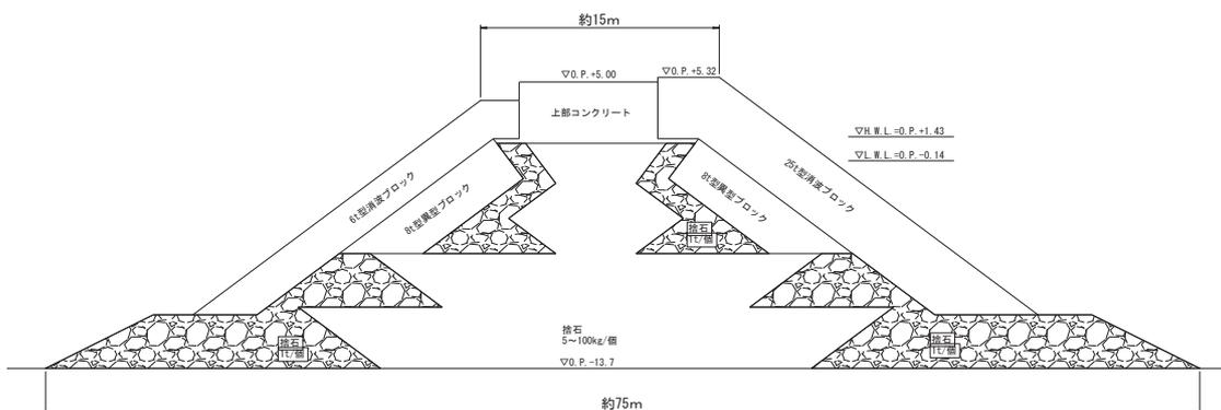
添付 6-3 図 東防波堤標準断面図
