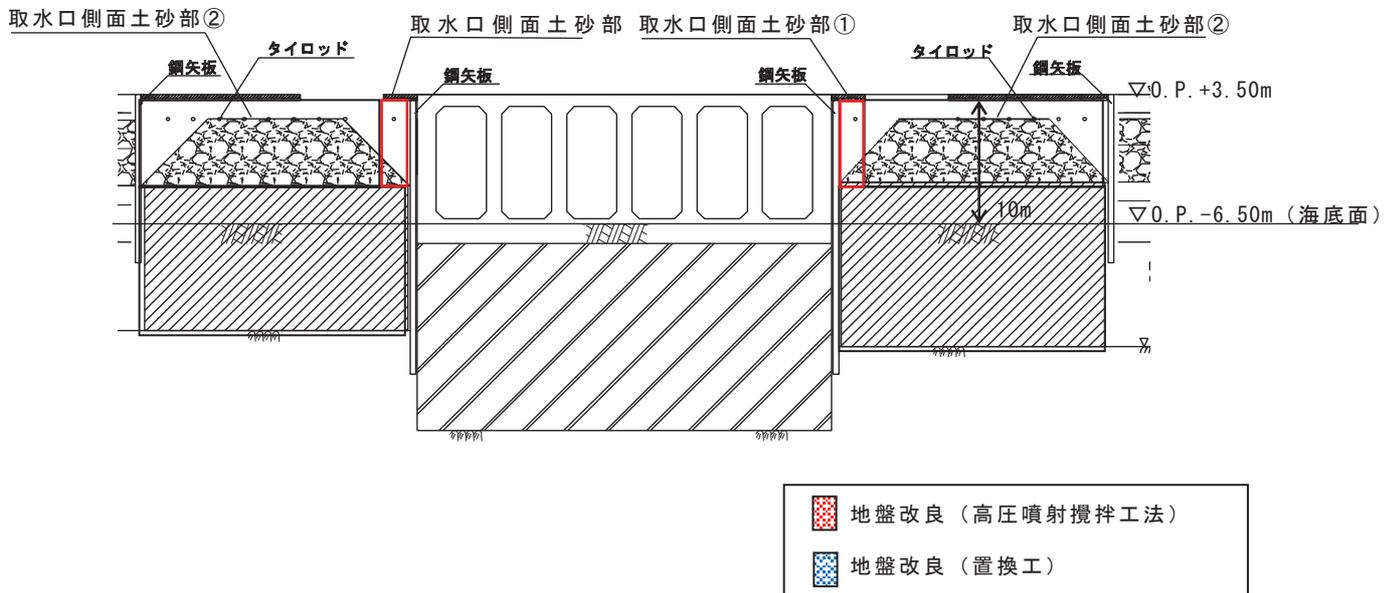
添付 6-8 図 前面護岸の断面図 (A-A 断面)
