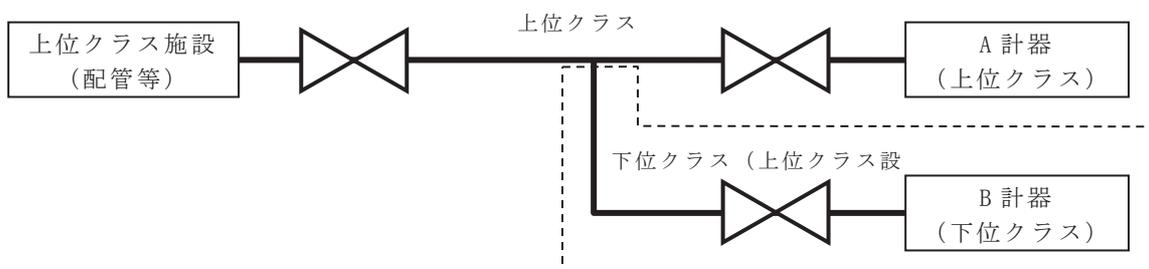
第 5.2-4 図 計装配管の耐震設計概念図
