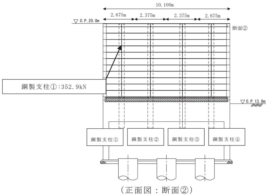
添付 8-6(3)図 第 3 号機除塵装置電源室による鋼製遮水壁（鋼板）の
