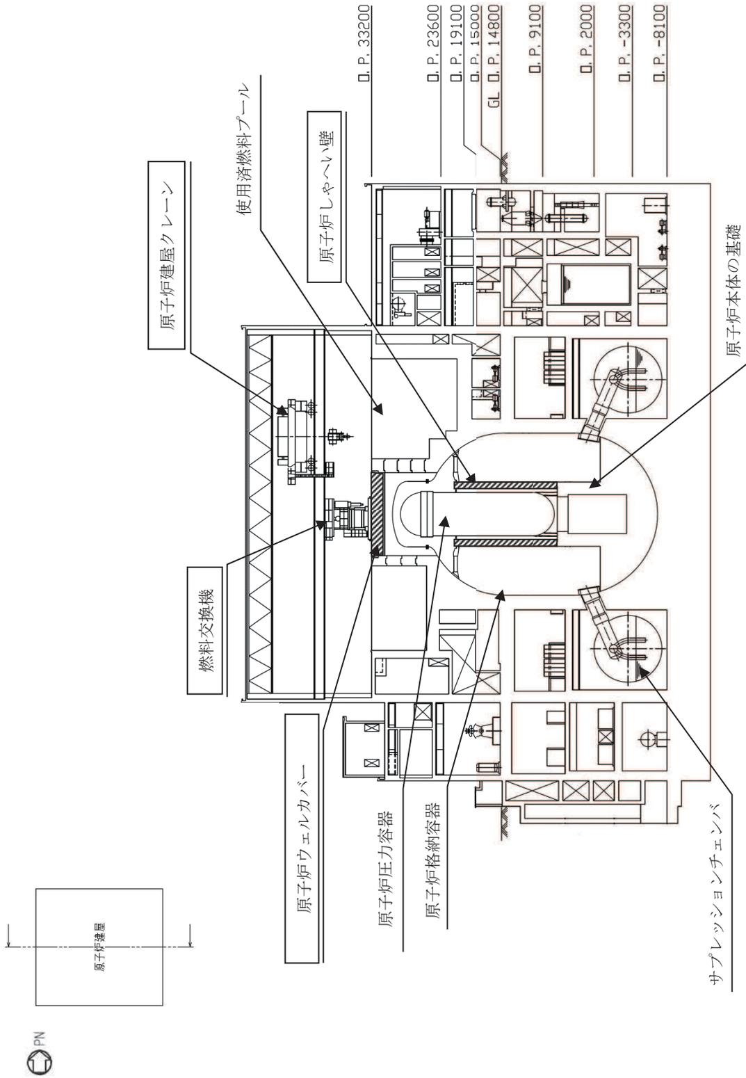
第 6.3-5 図 女川 2 号機 原子炉ウェルカバ及び原子炉しゃへい壁位置関係概要図
