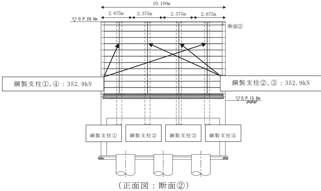
添付 8-6(2)図 第 3 号機除塵装置電源室による鋼製遮水壁（鋼板）の
