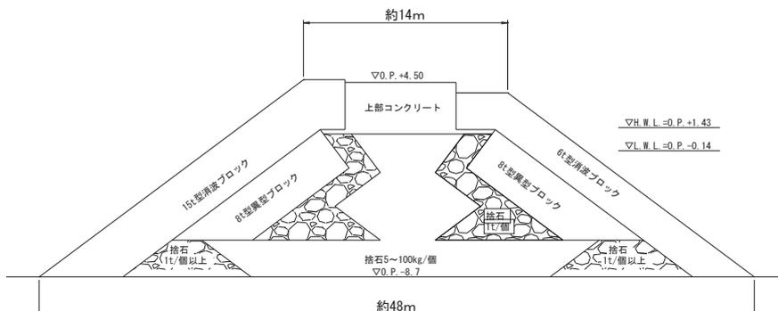
添付 6-4 図 北防波堤標準断面図
