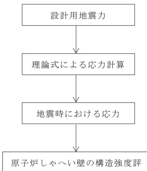
図 2-1 原子炉しゃへい壁の耐震評価フロー
