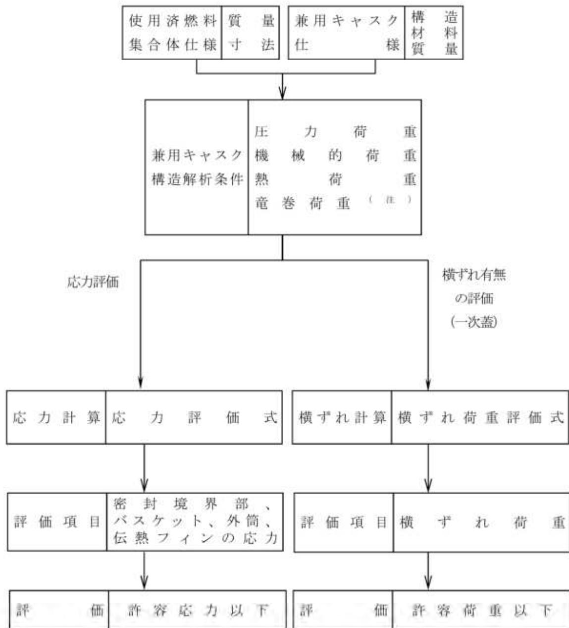
第1図 竜巻荷重作用時の機能維持評価フロー
