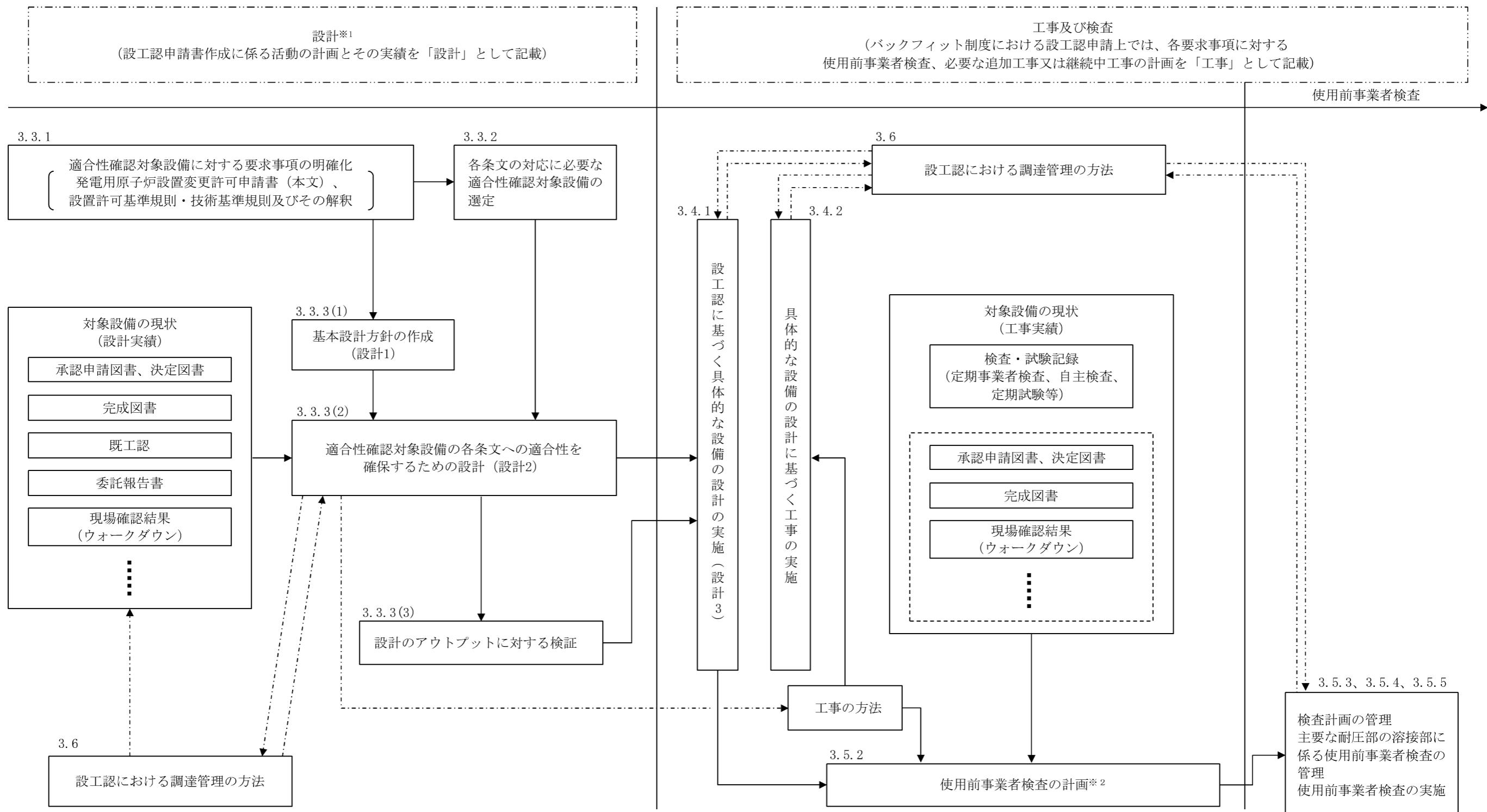
※1：バックフィット制度における設工認申請上の「設計」とは、要求事項を満足した設備とするための基本設計方針を作成（設計1）し、既に設置されている設備の状況を念頭に置きながら、適合性確認対象設備を各条文に適合させるための設計（設計2）を行う業務をいう。
