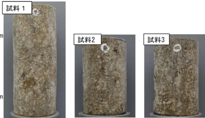
密度試験に用いた供試体の写真
