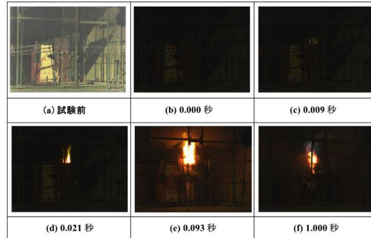
図5 高速度ビデオカメラを用いたHEAF事象解析の一例
