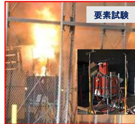
図3 筐体(試験体)を用いたHEAF試験
