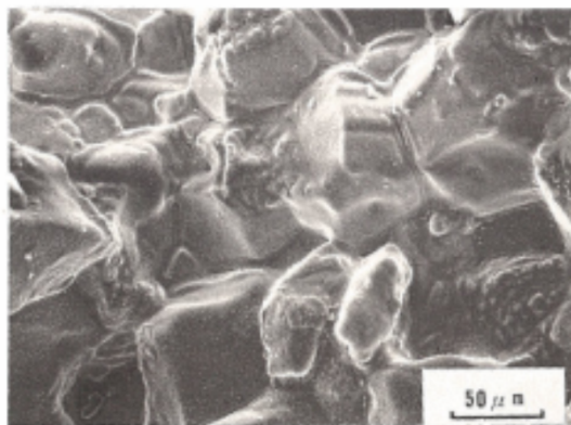
液化割れの例*3
