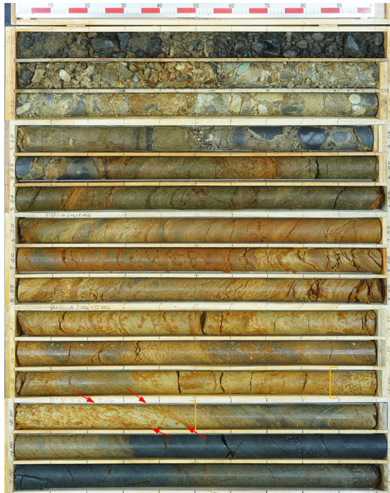
コア写真(確認-2ボーリング:深度0~15m)
