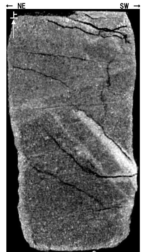
X線CT画像 (傾斜方向断面, 解釈線なし) (断面(B): 研磨片作成位置断面) 5cm
