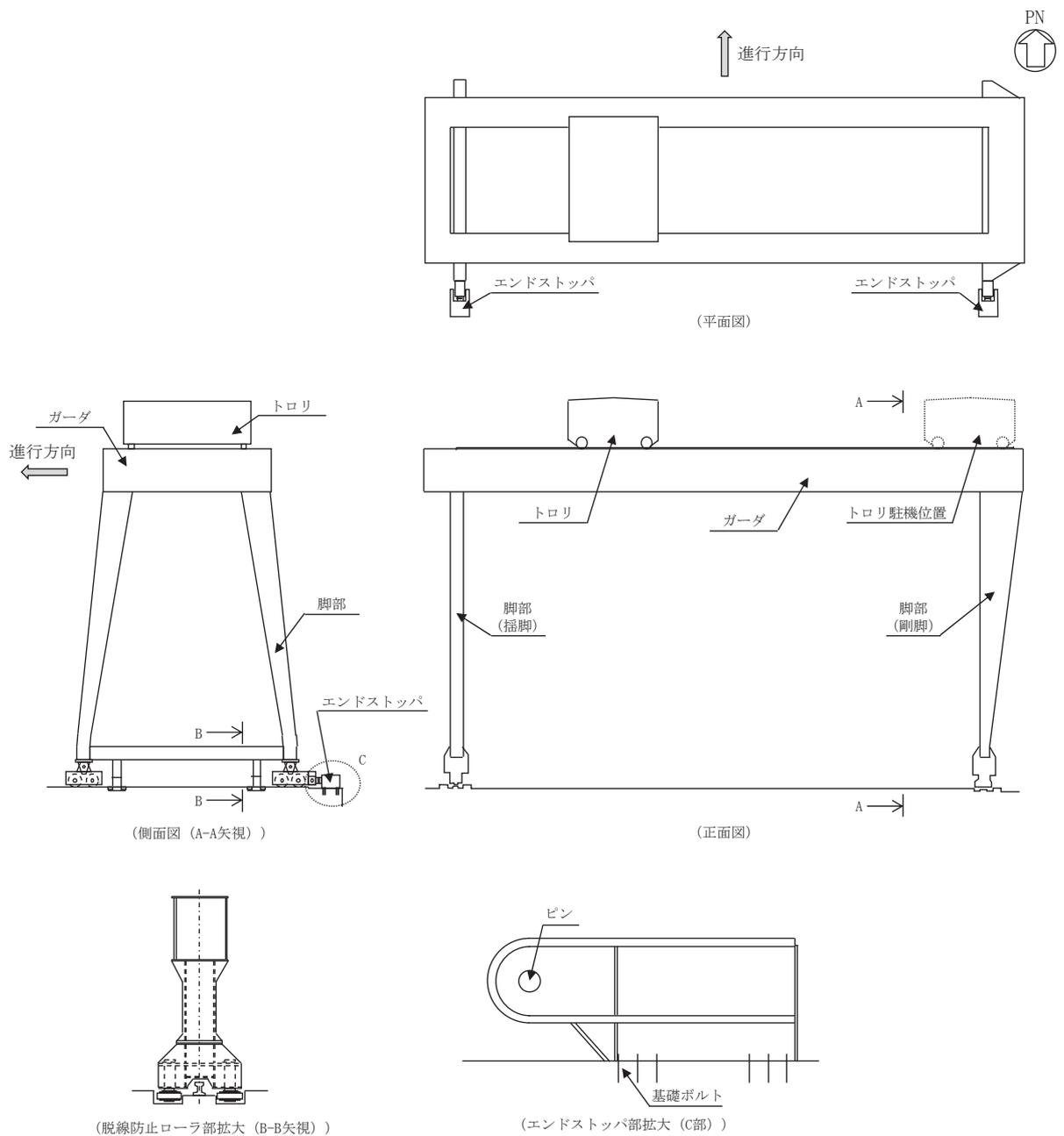
図 2-3 海水ポンプ室門型クレーンの概要図
