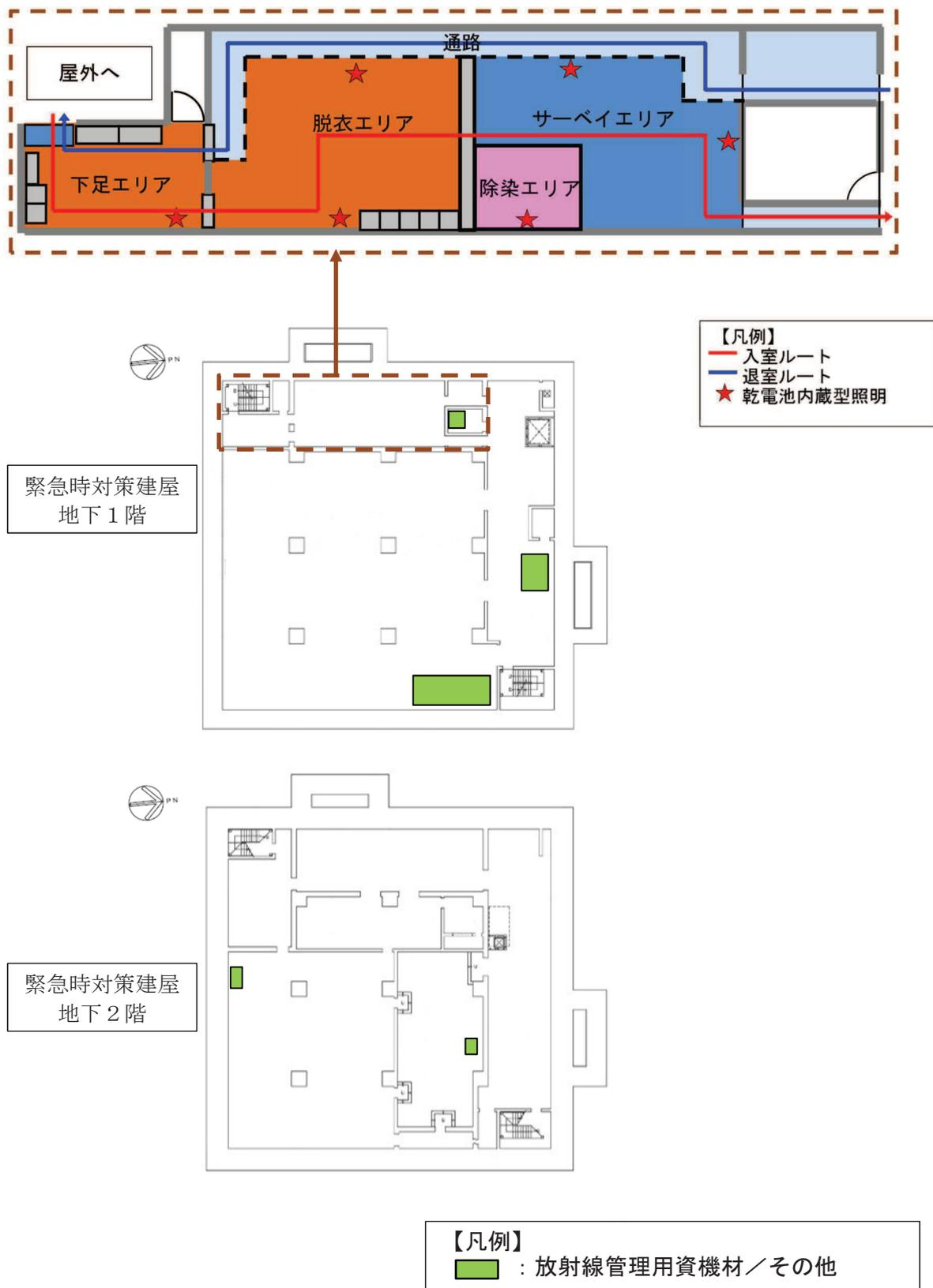
図 3-2 緊急時対策所チェンジングエリア設置場所及び配置
