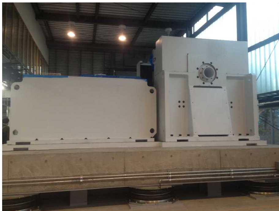
図3.5.1 導入中の振動試験設備
