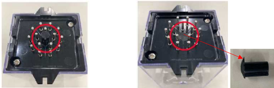
(a) 損傷前 (リレー底面)
