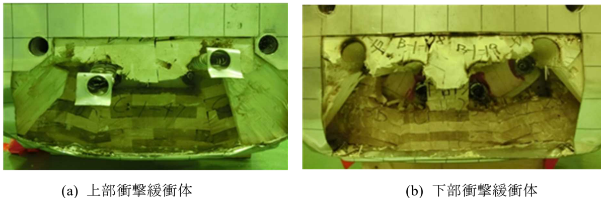
図 2.8.12 水平落下試験時の衝撃緩衝体の変形状況
