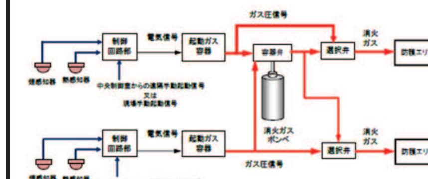
図 5-5 ハロンガス消火設備（全域：選択弁あり） 系統構成
