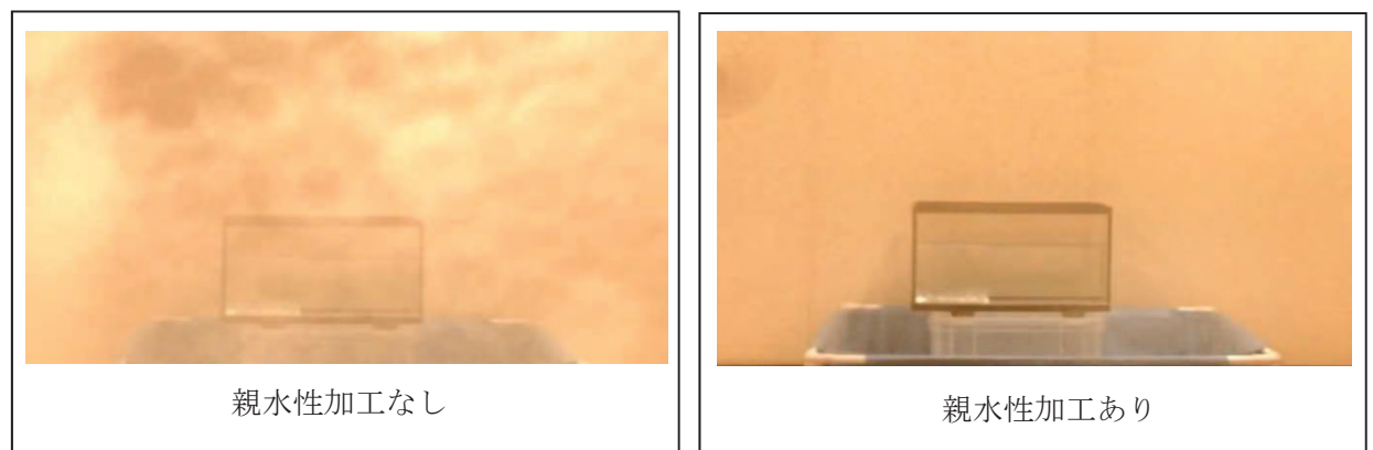
図 2.2.2-1 霧除去機能付きの可視光カメラの状態監視
