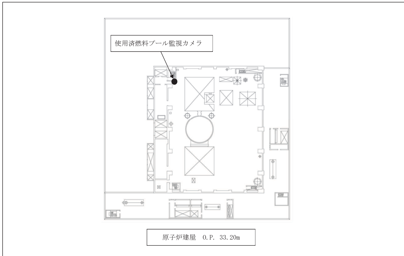
図 3.1-13 使用済燃料プール監視カメラの取付箇所を明示した図面
