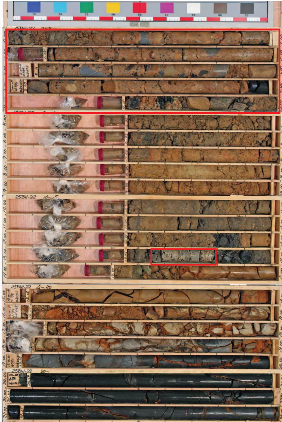
図 1-25(2) ボーリングコア写真 (25BW-22) (盛土：深度 0～14.48m)
