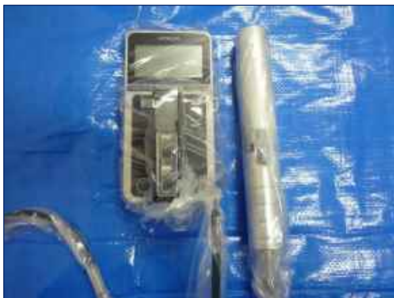
【NaI (Tl) シンチレーション式サーベイメータ養生の例】
