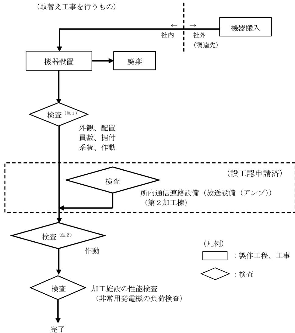
(注1) 通信連絡設備 所内通信連絡設備（放送設備（スピーカ））は、図リー他-12（1）に示すとおり、第2加工棟の通信連絡設備 所内通信連絡設備（放送設備（アンプ））に接続する。第2加工棟の通信連絡設備 所内通信連絡設備（放送設備（アンプ））は、第4次設工認で申請済みであり、作動の検査には放送設備（アンプ）に付属するマイクを使用する。
