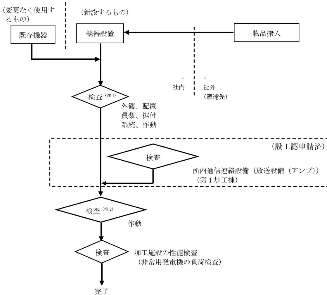
(注1) 通信連絡設備 所内通信連絡設備（放送設備（スピーカ））は、図リー他-12（1）に示すとおり、第1加工棟の通信連絡設備 所内通信連絡設備（放送設備（アンプ））に接続する。第1加工棟の通信連絡設備 所内通信連絡設備（放送設備（アンプ））は、第3次設工認で申請済みであり、作動の検査には放送設備（アンプ）に付属するマイクを使用する。
