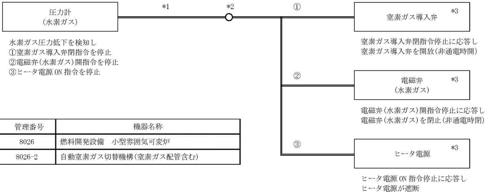
\*1 : 信号線断線時はヒータ電源が遮断、窒素ガス導入弁が開放、電磁弁(水素ガス)が閉止
