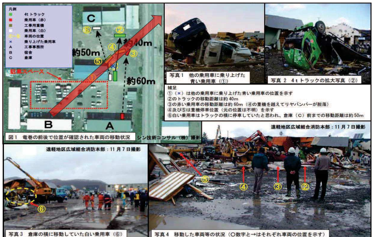
図34 佐呂間竜巻(2006.11.7)による被災状況(工事事務所敷地内の車両被災) (25)
