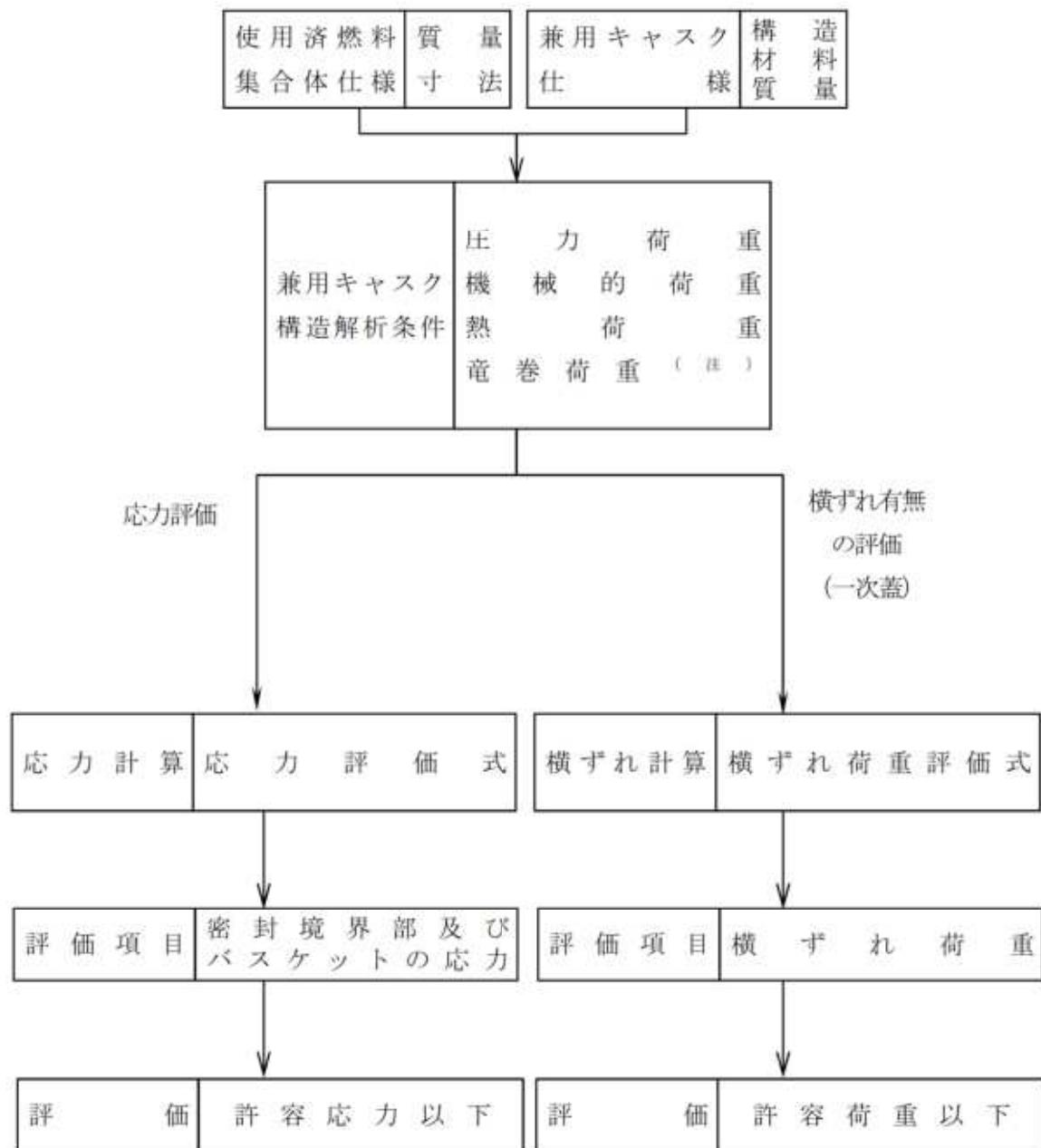
(注) 竜巻荷重として、風圧力による荷重、気圧差による荷重及び設計飛来物による衝撃荷重を考慮する。
