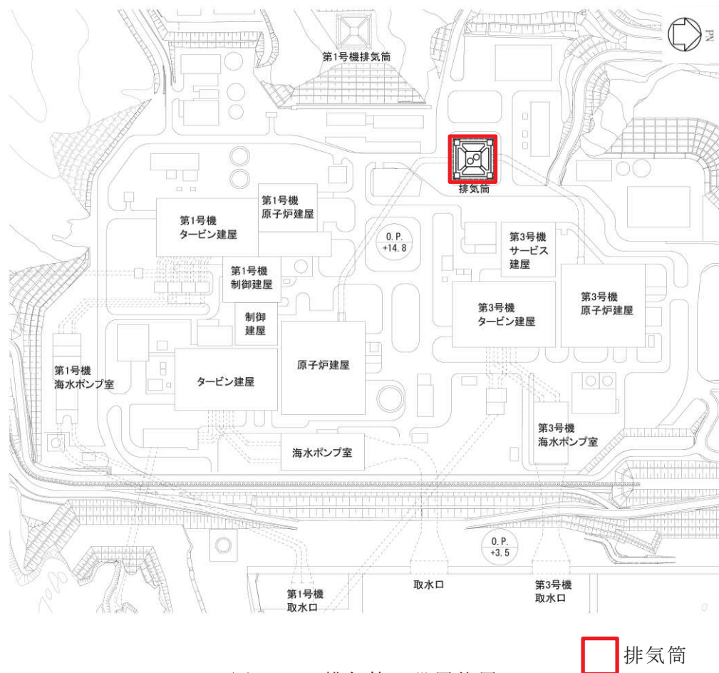
図 2-1 排気筒の設置位置
