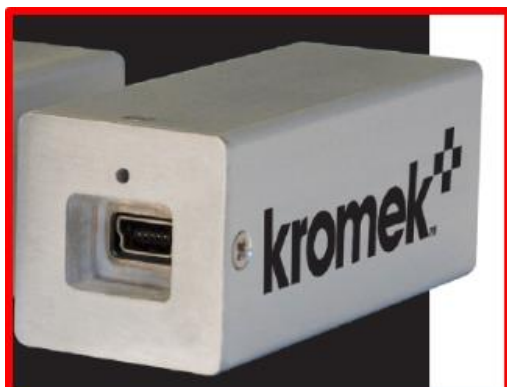
スペクトルサーベイメータ kromek社製 GR1(CdZnTe結晶)
