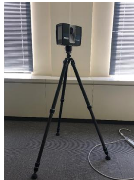
スキャナ ※三脚に設置した状態
