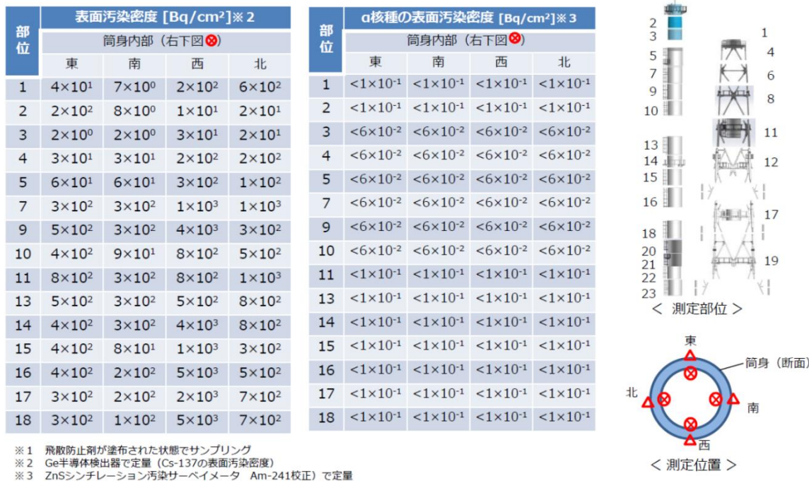
図1-2-1-3 1/2号機共用排気筒 1~18ブロック目解体部材の表面汚染密度の測定結果 (東京電力調査)
