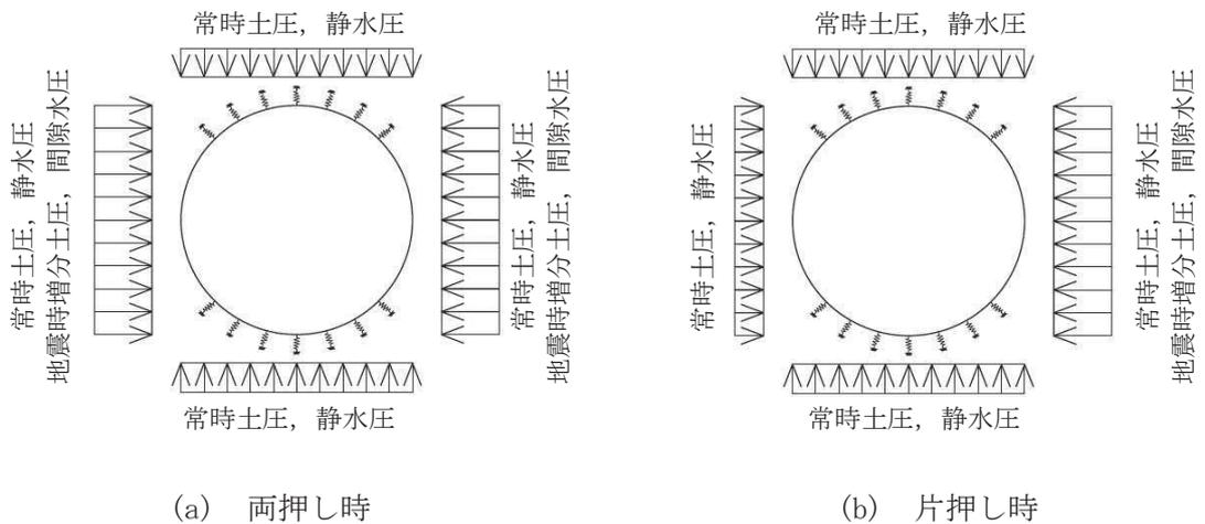
図3-19 二次元静的フレイム解析モデルの概念図（排水シャフト）
