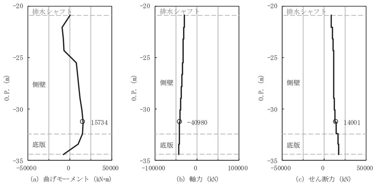
図 4-12 集水ピット 軸方向照査におけるコンクリートの曲げ・軸力系の破壊に対する
