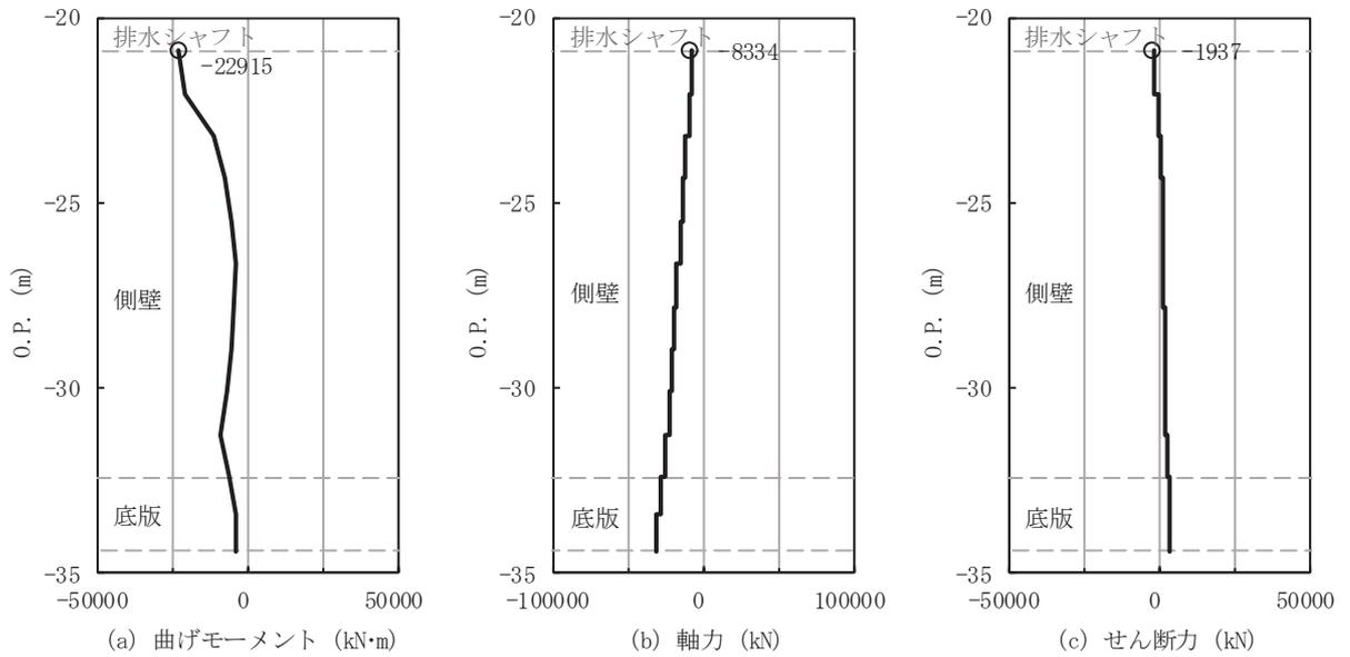
図 4-13 集水ピット 軸方向照査における鉄筋の曲げ・軸力系の破壊に対する
