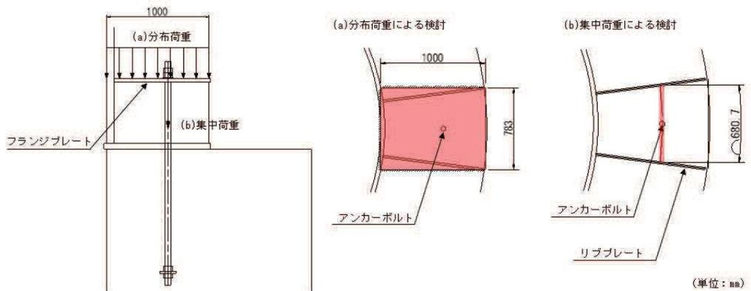
図3-28 フランジプレート検討概念図
