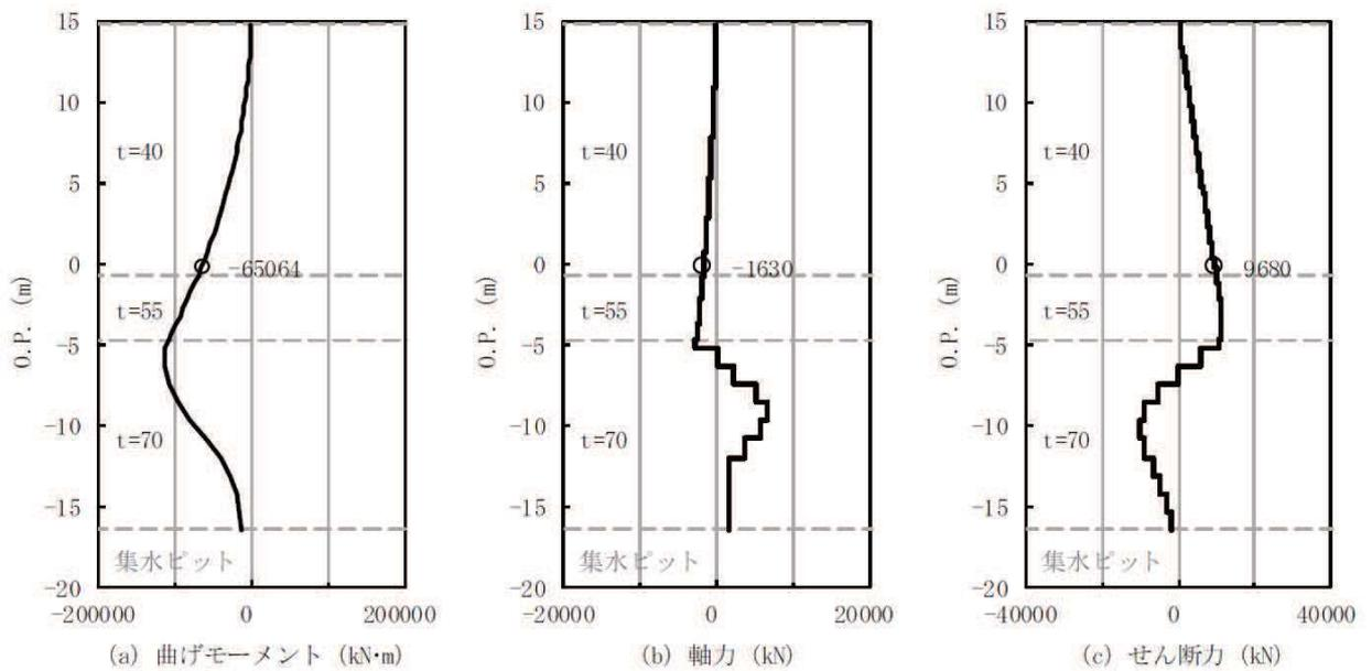
図 4-2 排水シャフト 軸方向照査におけるせん断破壊に対する評価時刻での断面力
