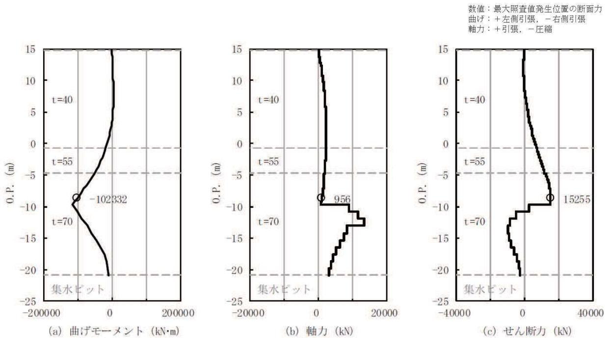
図 4-5 排水シャフト 軸方向照査におけるせん断破壊に対する評価時刻での断面力
