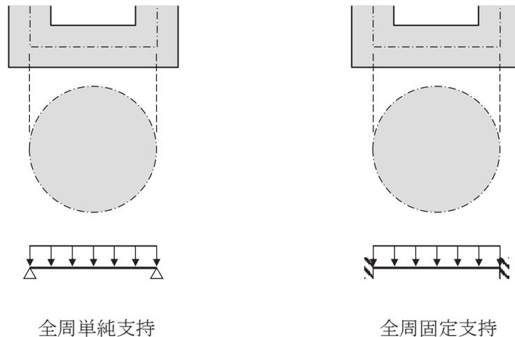
図 3-22 底版の検討モデル（円板）の概念図
