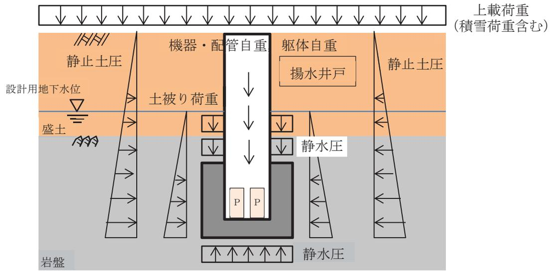
図 3-7 揚水井戸の荷重概要図
