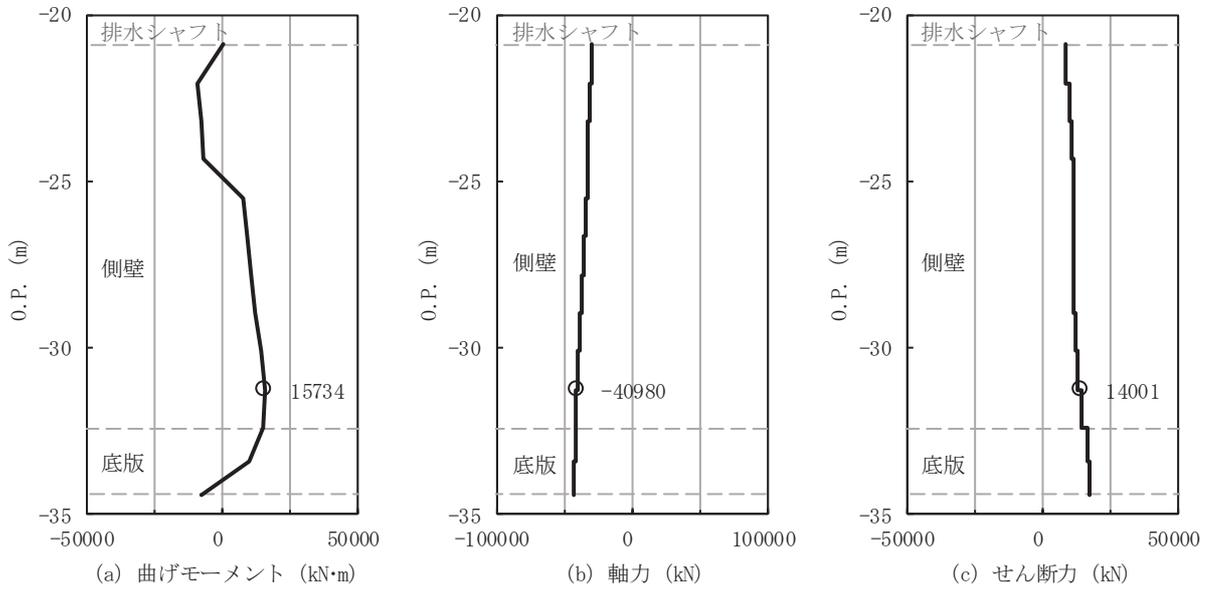
図 4-14 集水ピット 軸方向照査におけるせん断破壊に対する評価時刻での断面力
