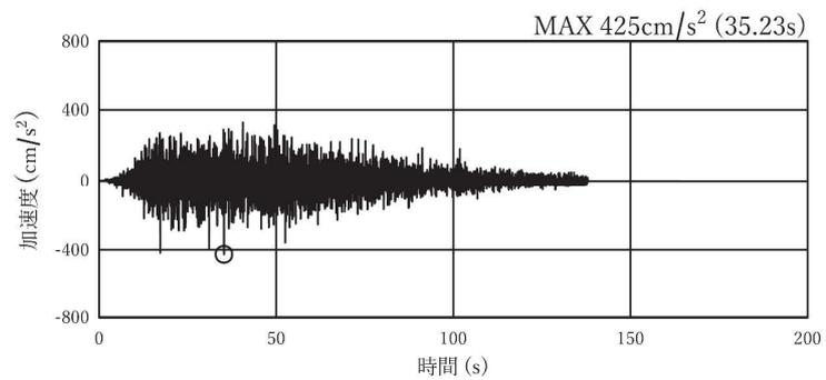
図 4-1(7) 加速度時刻歴波形 (断面④) (鉛直方向: S s - D 1:地盤物性ケース③)
