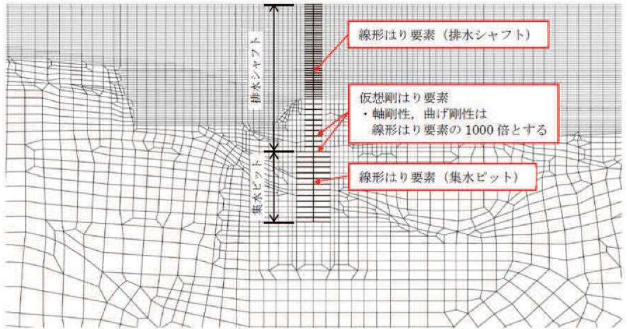
図3-14(1) 構造物モデルの概要 (No.1 揚水井戸)
