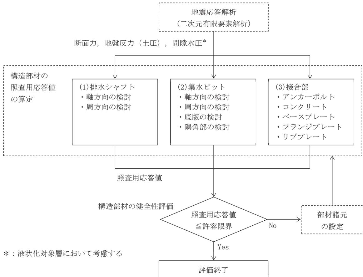
図 2-5 揚水井戸の詳細耐震評価フロー
