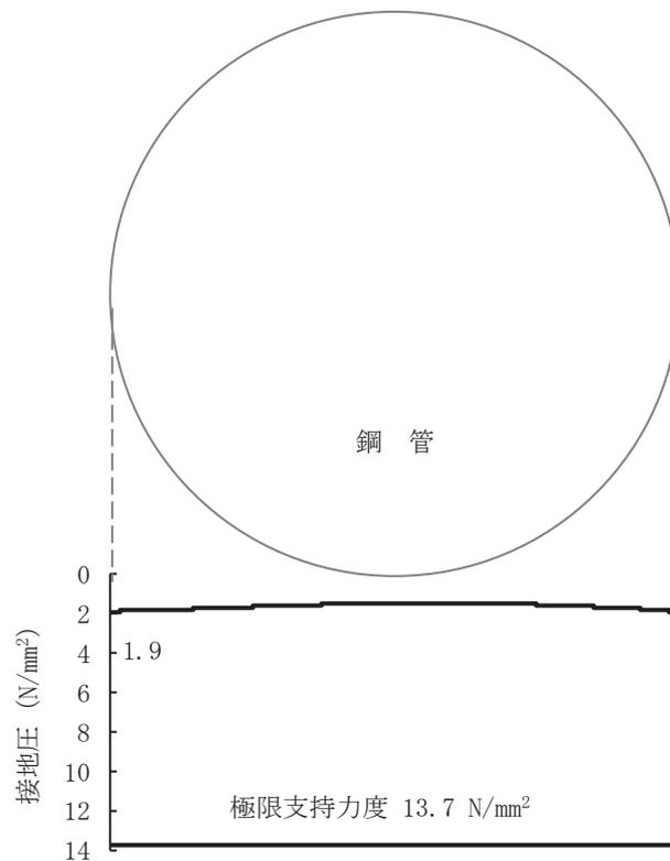
図 4-4 鋼管の接地圧分布図 (S<sub>s</sub>-N1, EW 断面)
