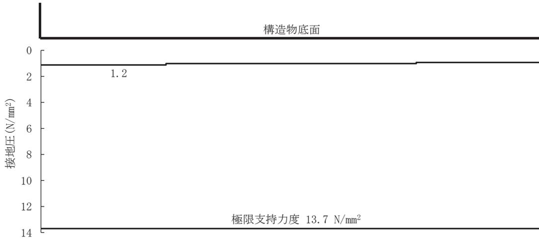
図 4-17(2) 最大接地圧分布図
