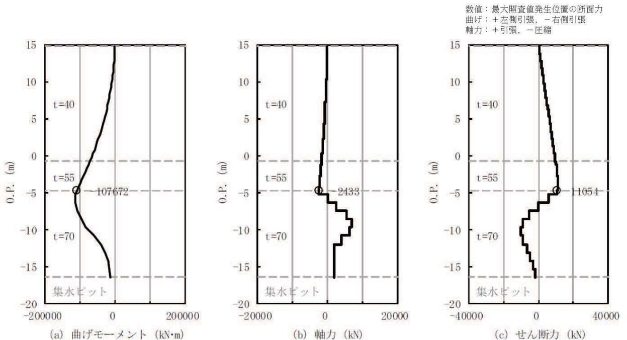
図 4-1 排水シャフト 軸方向照査における曲げ・軸力系の破壊に対する評価時刻での断面力
