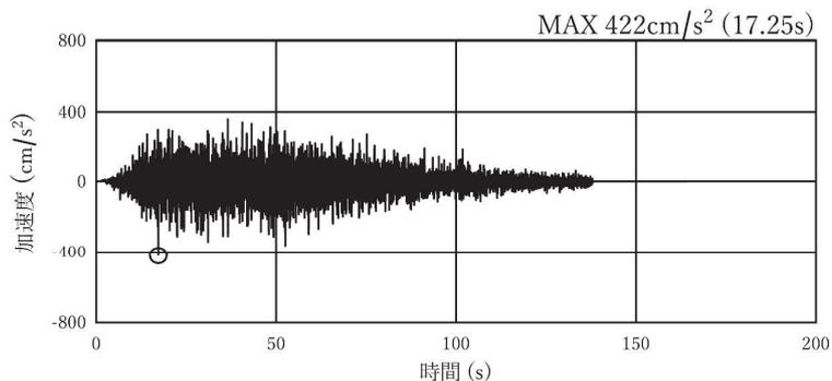
図 4-1(8) 加速度時刻歴波形（接続榫④）（鉛直方向：S s - D 1 : 解析ケース②）
