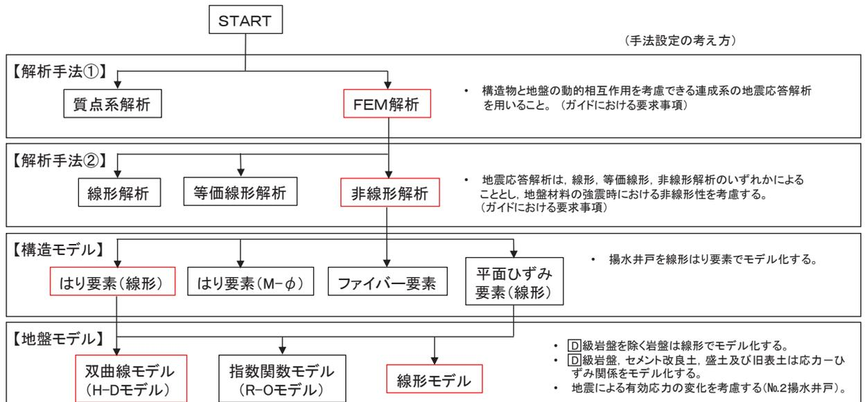
図3-3 地震応答解析手法の選定フロー
