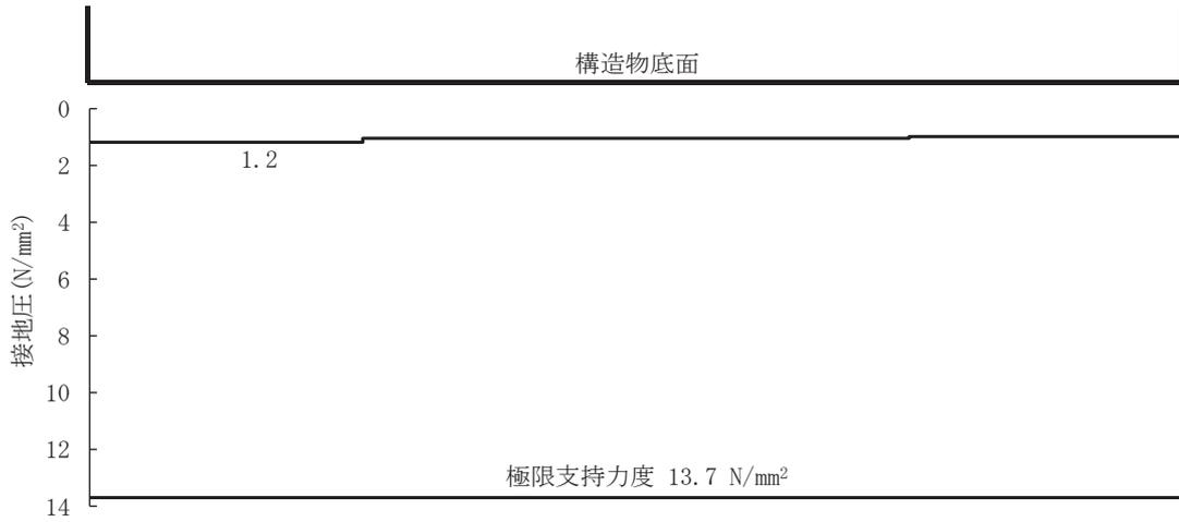
図 4-17(1) 最大接地圧分布図
