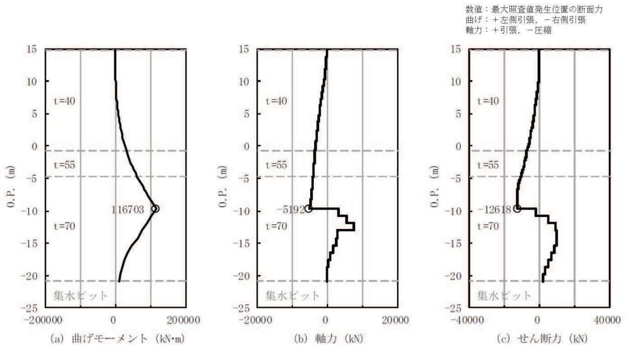
図 4-4 排水シャフト 軸方向照査における曲げ・軸力系の破壊に対する評価時刻での断面力
