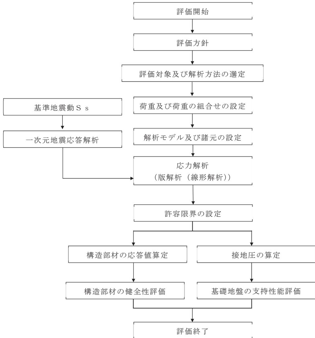
図 2-3 接続桝の評価フロー
