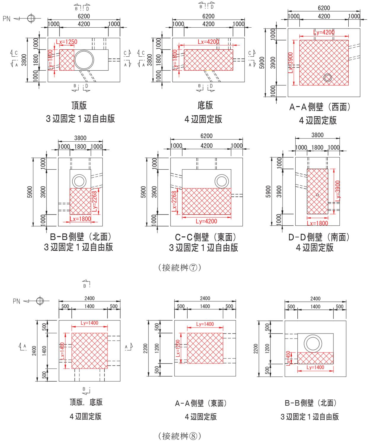
図 3-9(4) 接続柵の解析モデル ( $L_x$  : 短辺,  $L_y$  : 長辺) (単位 : mm)
