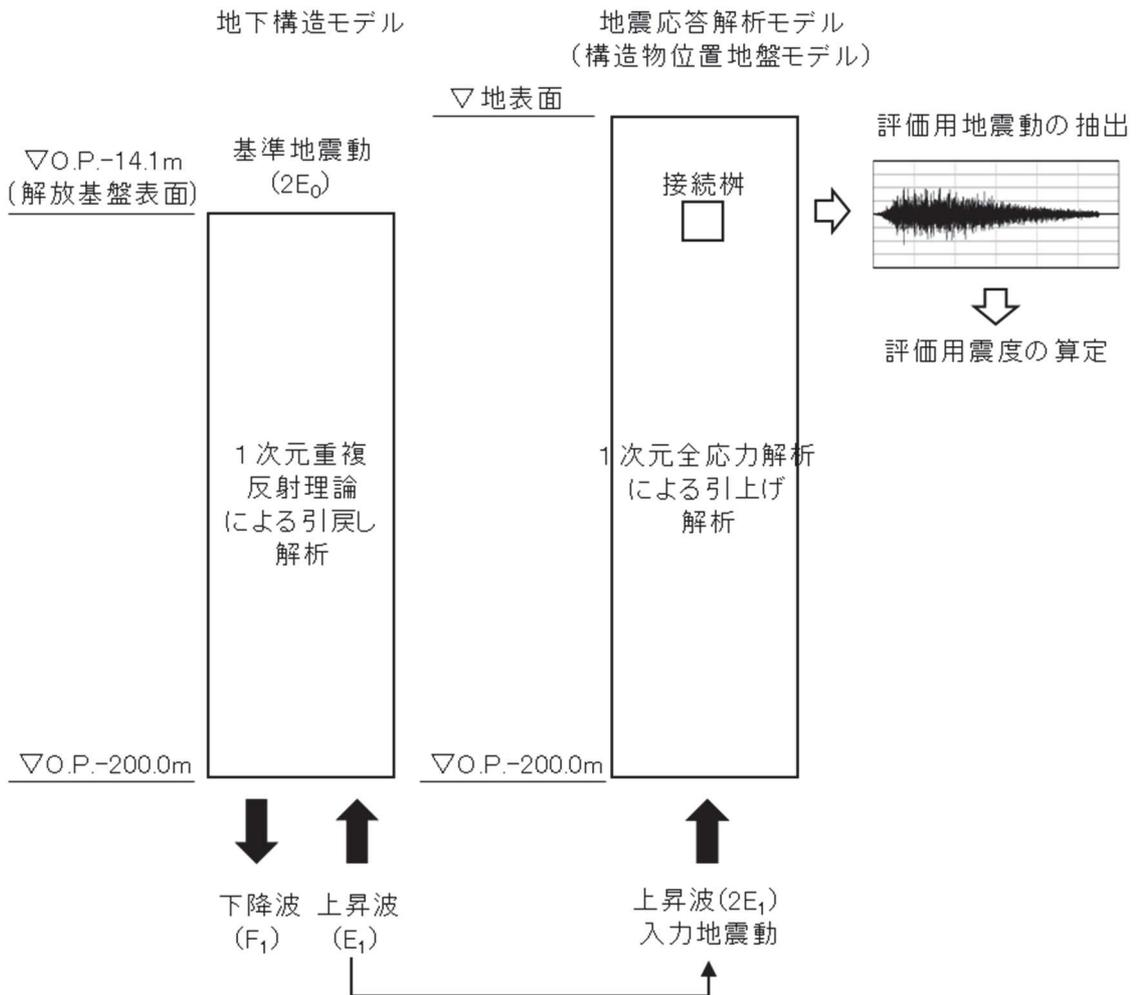
図 3-6 地震応答解析の概念図
