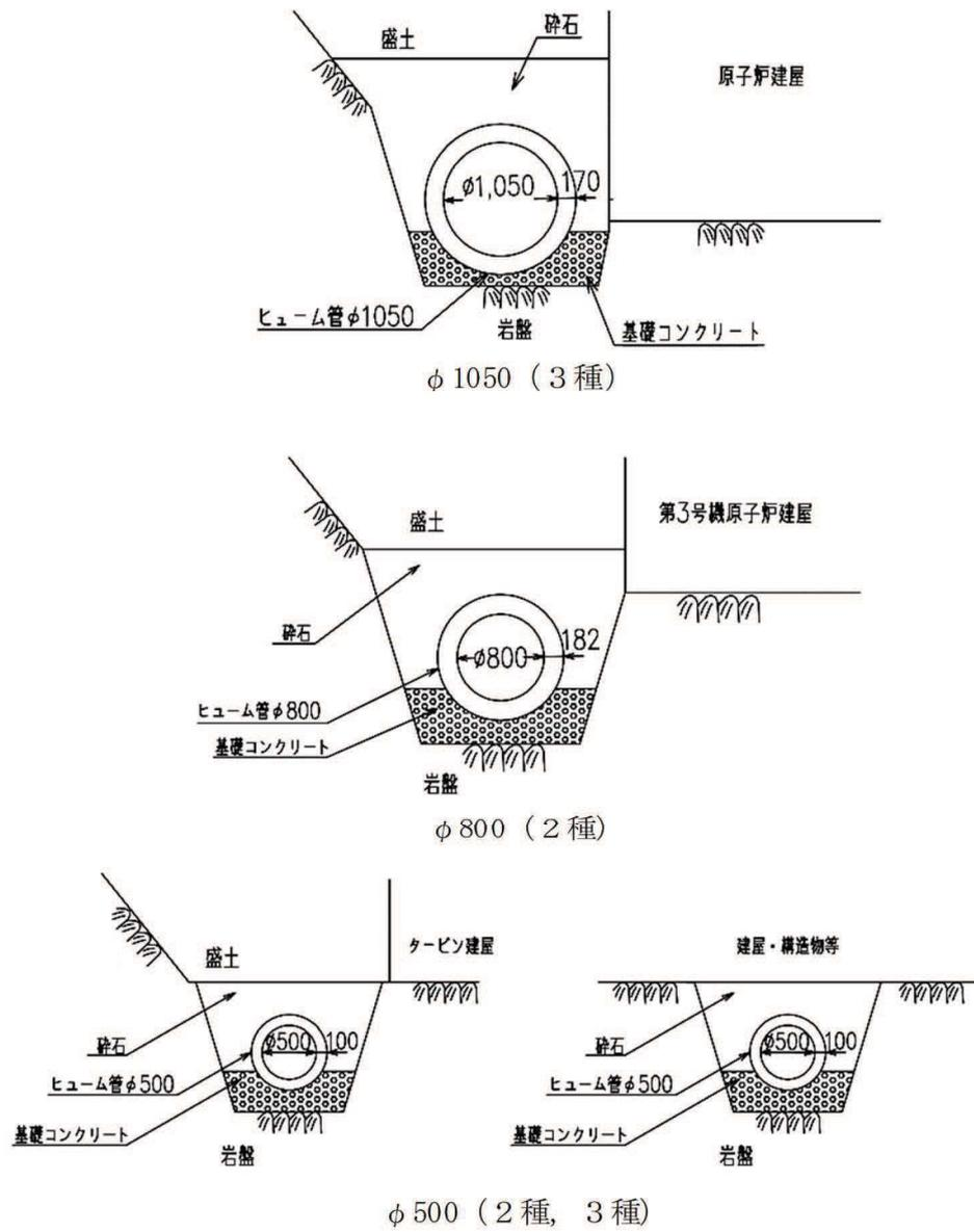
図 2-3 ヒューム管の構造概要 (単位: mm)
