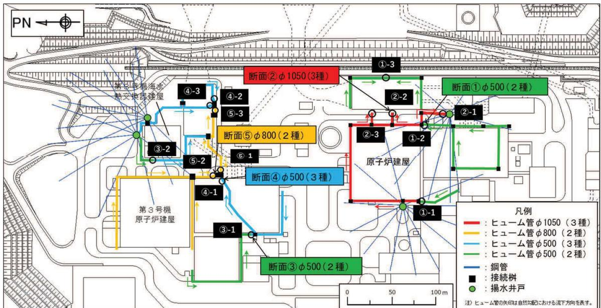
図3-1 ヒューム管評価対象断面候補位置
