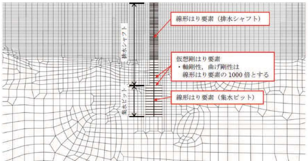
図3-14(2) 構造物モデルの概要 (No.2 揚水井戸)
