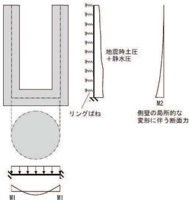
図 3-23 隅角部の評価の概念図
