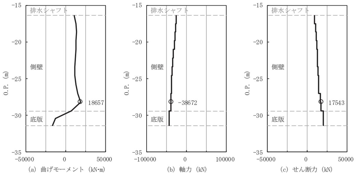
図 4-7 集水ピット 軸方向照査におけるコンクリートの曲げ・軸力系の破壊に対する
