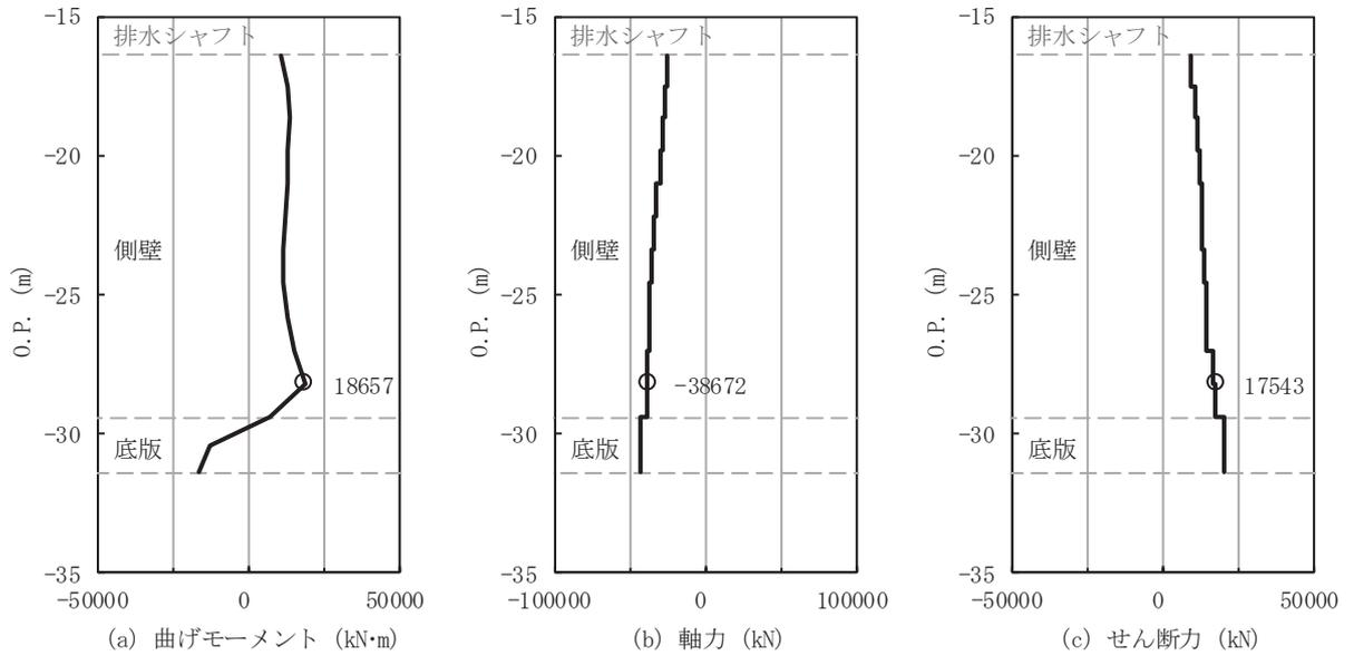
図 4-9 集水ピット 軸方向照査におけるせん断破壊に対する評価時刻での断面力
