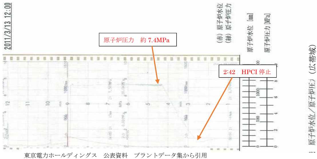
図6 原子炉水位／原子炉圧力（広帯域）
