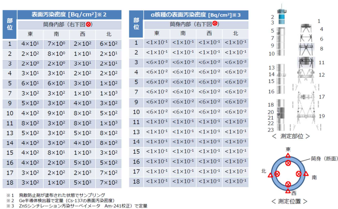
図13 1/2号機共用排気筒 1~18ブロック目解体部材の表面汚染密度の測定結果 (東京電力調査)
